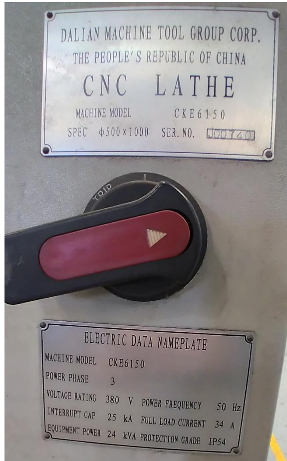
Imagen 1.3.2. Placa característica del torno CNC
