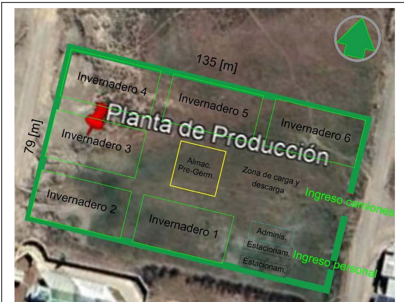
**Figura 3.38** - Distribución de planta implantada en imagen satelital
