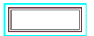
VII: VENTILUZ DE ALUMINIO PINTADO, DOBLE VIDRIO ENTERO DE 4 MM Y CÁMARA DE AIRE DE 12 MM (0.75 X 0.35)
