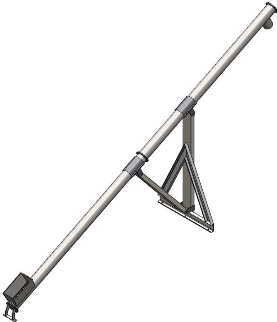
MC-F-51 -Estructura rosca transportadora . (Elaboración propia)
