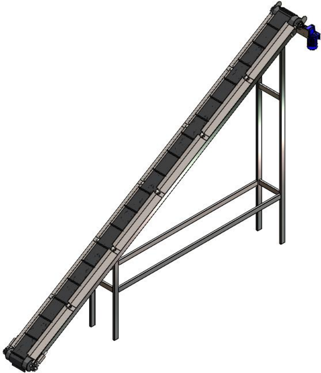
MC-F-25-Cinta transportadora T-CT-02. (Elaboración propia)
