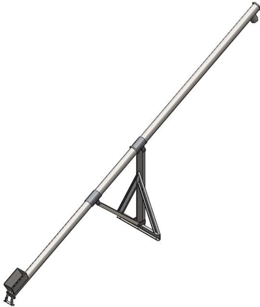
MC-F-33 -Estructura rosca transportadora. (Elaboración propia)
