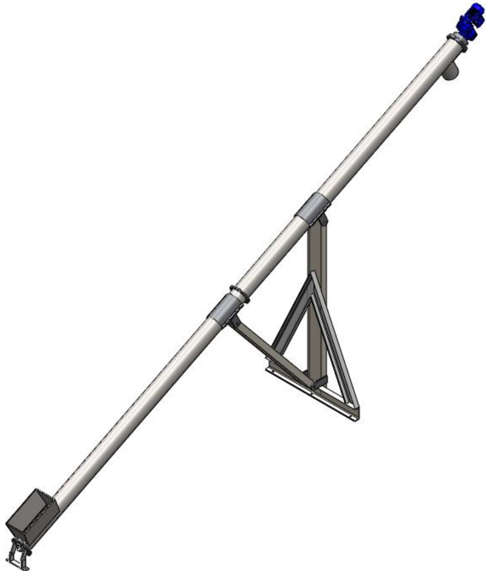
MC-F-52-Rosca transportadora T-RT-03. (Elaboración propia)
