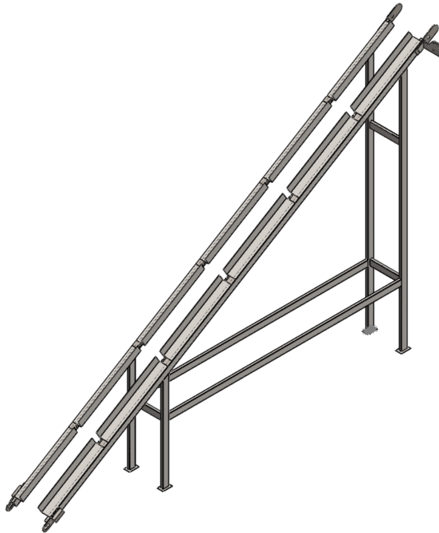
MC-F-24 -Estructura cinta transportadora T-CT-02 . (Elaboración propia)
