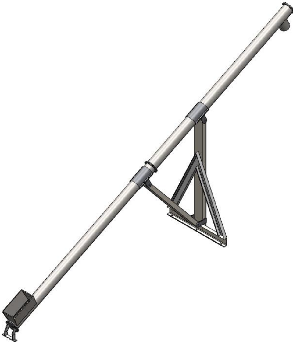
MC-F-42 -Estructura rosca transportadora. (Elaboración propia)
