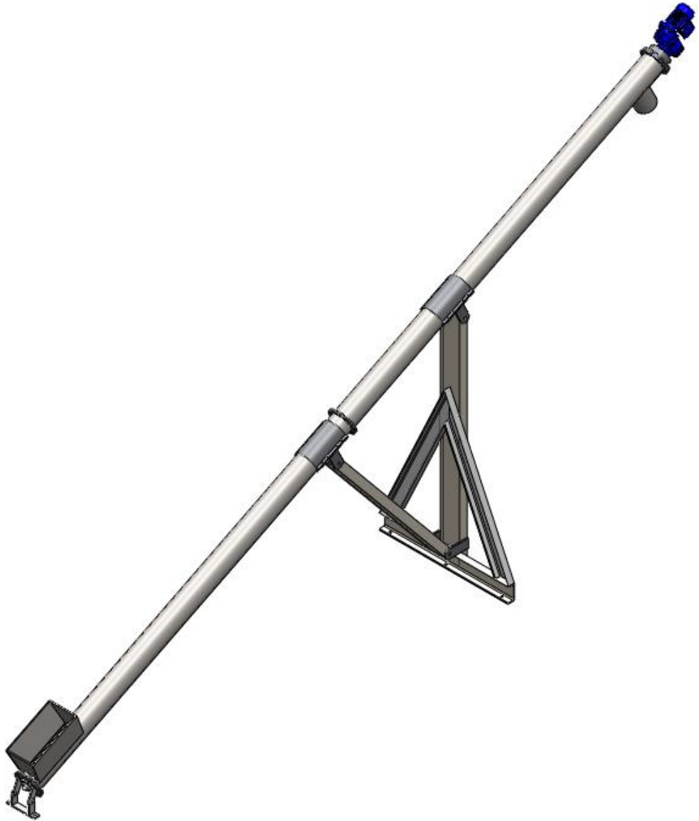
MC-F-43-Rosca transportadora T-RT-02. (Elaboración propia)
