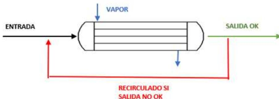
Figura 8.2.A. Esquema de arranque de un intercambiador.
