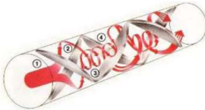
Figura 7.4.2.A. Funcionamiento mezcladores estáticos
