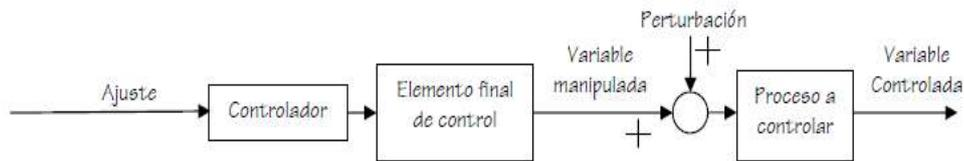
Diagrama de bloques típico de un sistema de control de lazo abierto
