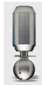
El líquido de lavado impulsa un simple motor rotativo, que impulsa la bola giratoria. Todo el líquido de lavado sale de la unidad a través del pequeño número de agujeros grandes. El diseño especial de los orificios garantiza que los chorros de alta potencia utilizan la cantidad mínima de líquido de lavado para ofrecer un rendimiento óptimo.
