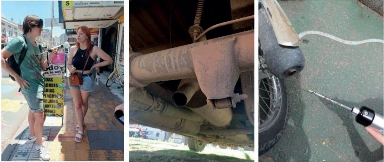
**Figura 4.** Medición de CO en el humo de cigarrillo exhalado por una persona fumadora que transitaba en el lugar, de los gases de salida del caño de escape de una camioneta diésel y de una moto (20/12/2021 - mediodía).
