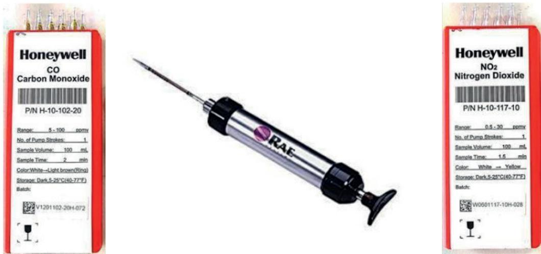
**Figura 2.** Bomba manual de pistón para aire de bajo caudal marca RAE (LP-1200) y tubos colorimétricos marca Honeywell para CO y NO<sub>2</sub>.
