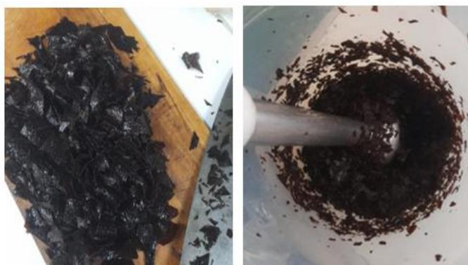
Ilustración 17: Corte de muestra y posterior trituración de la muestra. Fuente: Elaboración propia.
