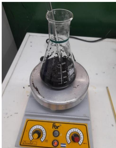
Ilustración 26: Se añaden 100 ml de solución de metóxido de potasio utilizando una probeta de 25 ml y luego es llevado a 60°C. Fuente: Elaboración propia.
