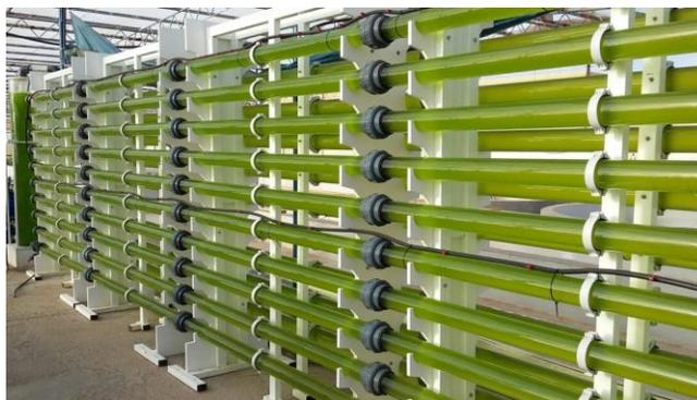
Ilustración 39: Ejemplo de Fotobiorreactores tubulares. Fuente: (Biotech and Sostenibility, s. f.)
