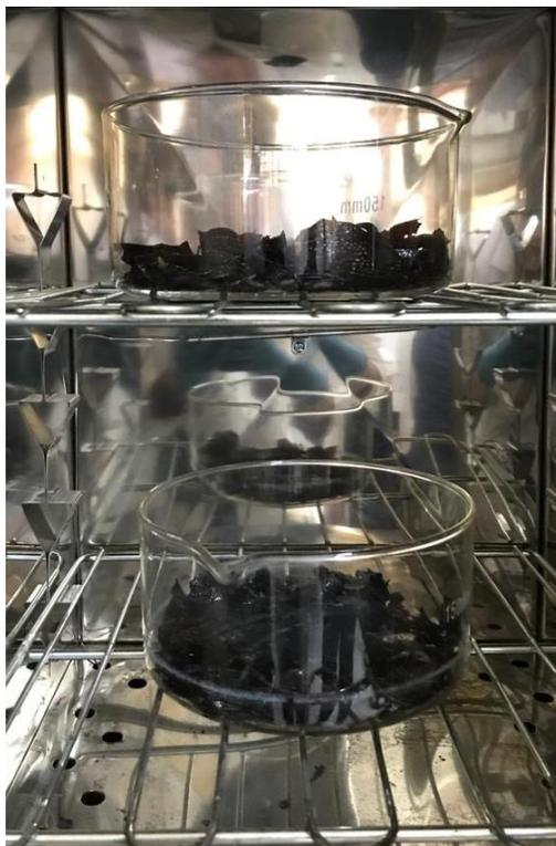
Ilustración 18: Dos cristalizadores con muestras de 40 g en la estufa. Fuente: Elaboración propia.
