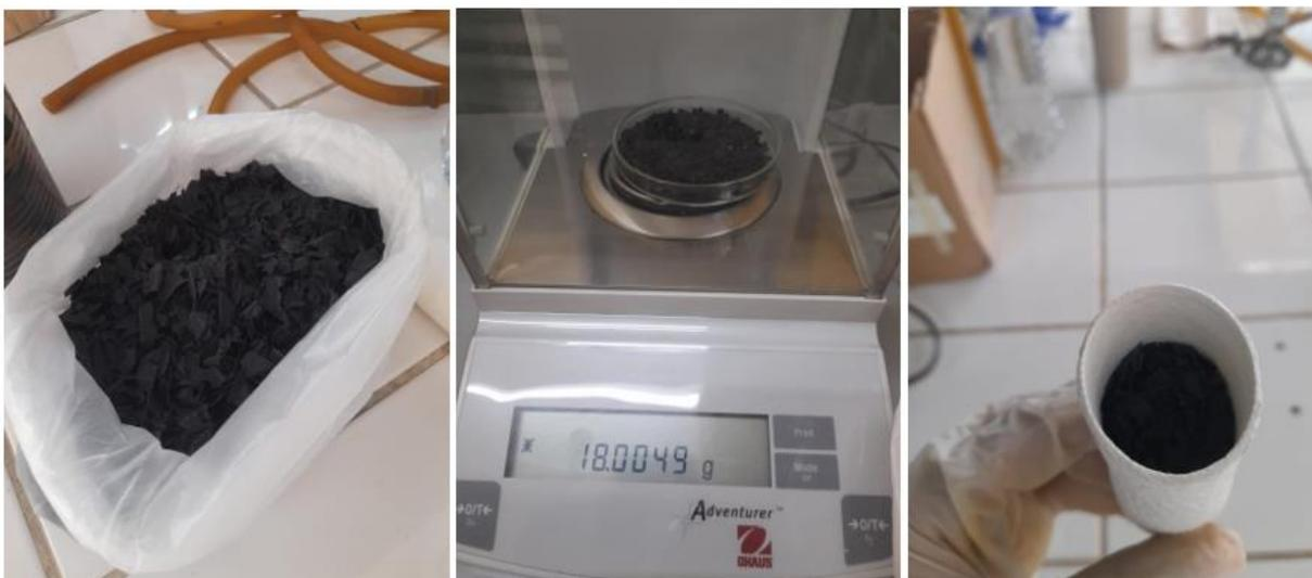
Ilustración 21: Pesada de la muestra algal y colocación en el cartucho de celulosa. Fuente: Elaboración propia.
