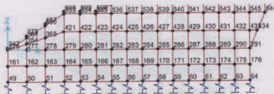
Las dimensiones de las bases surgieron de un análisis interactivo aplicado en la costilla interior central, el cual tenía como variables en juego, por un lado las dimensiones de las bases y por otro las tensiones admisibles del terreno.
