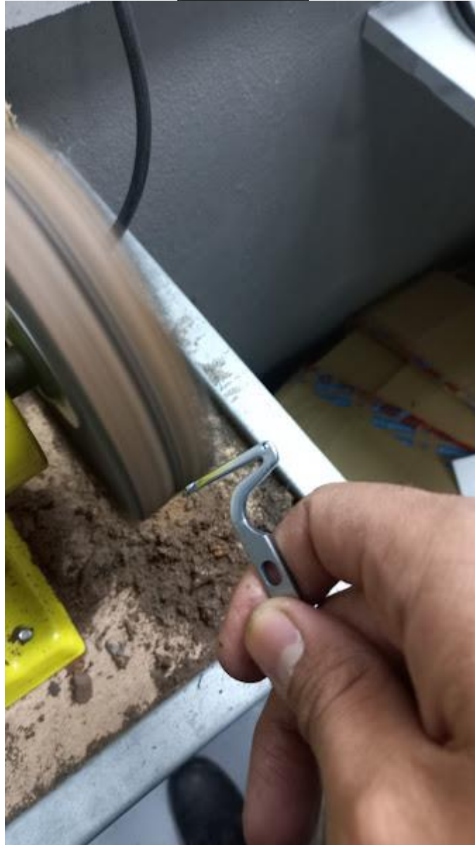
Pulido de crochet en tela de pulir en esmeril.
