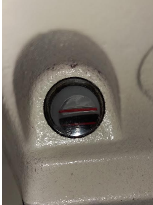
Nivel de aceite en máquina Overlock.
