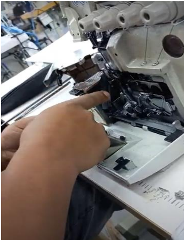
Regulación del tope de pie prensatela
