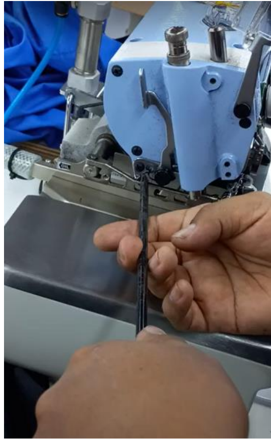
Regulación del tope de pie prensatela
