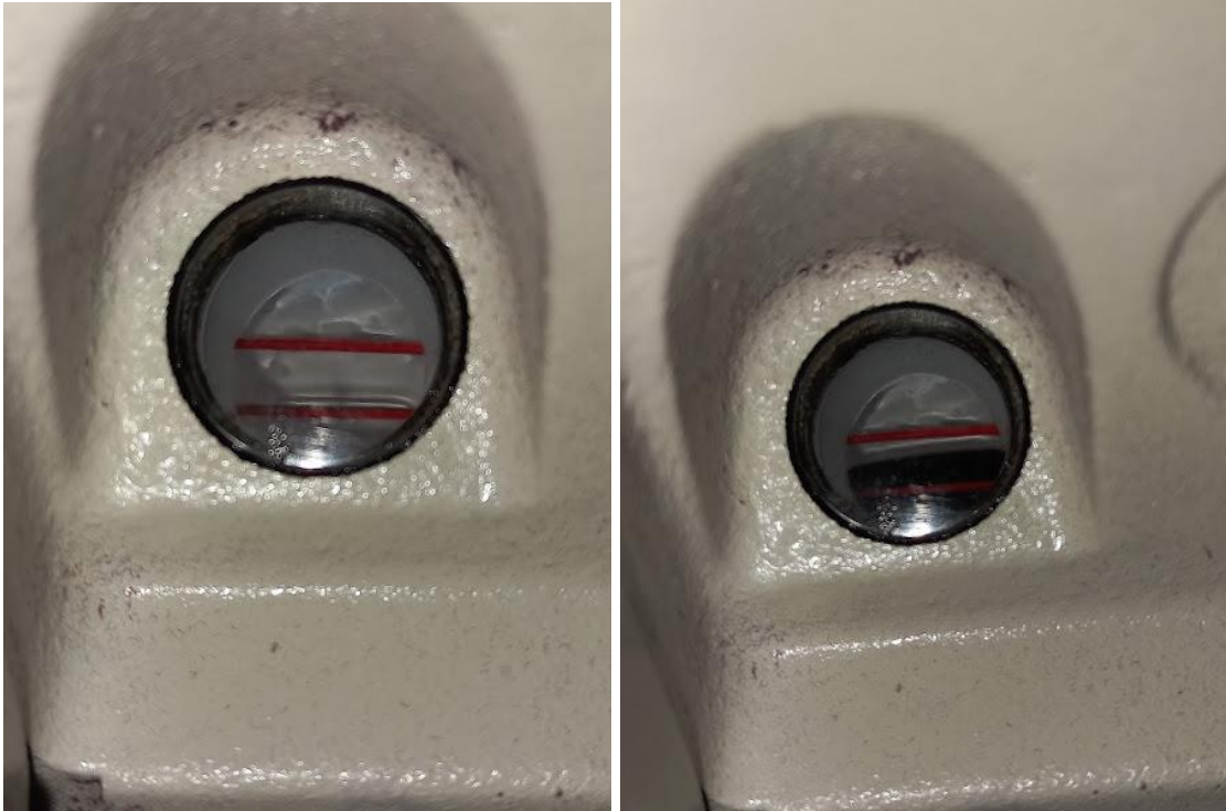
Mirilla indicadora de nivel de aceite, vacía y con aceite nuevo.
