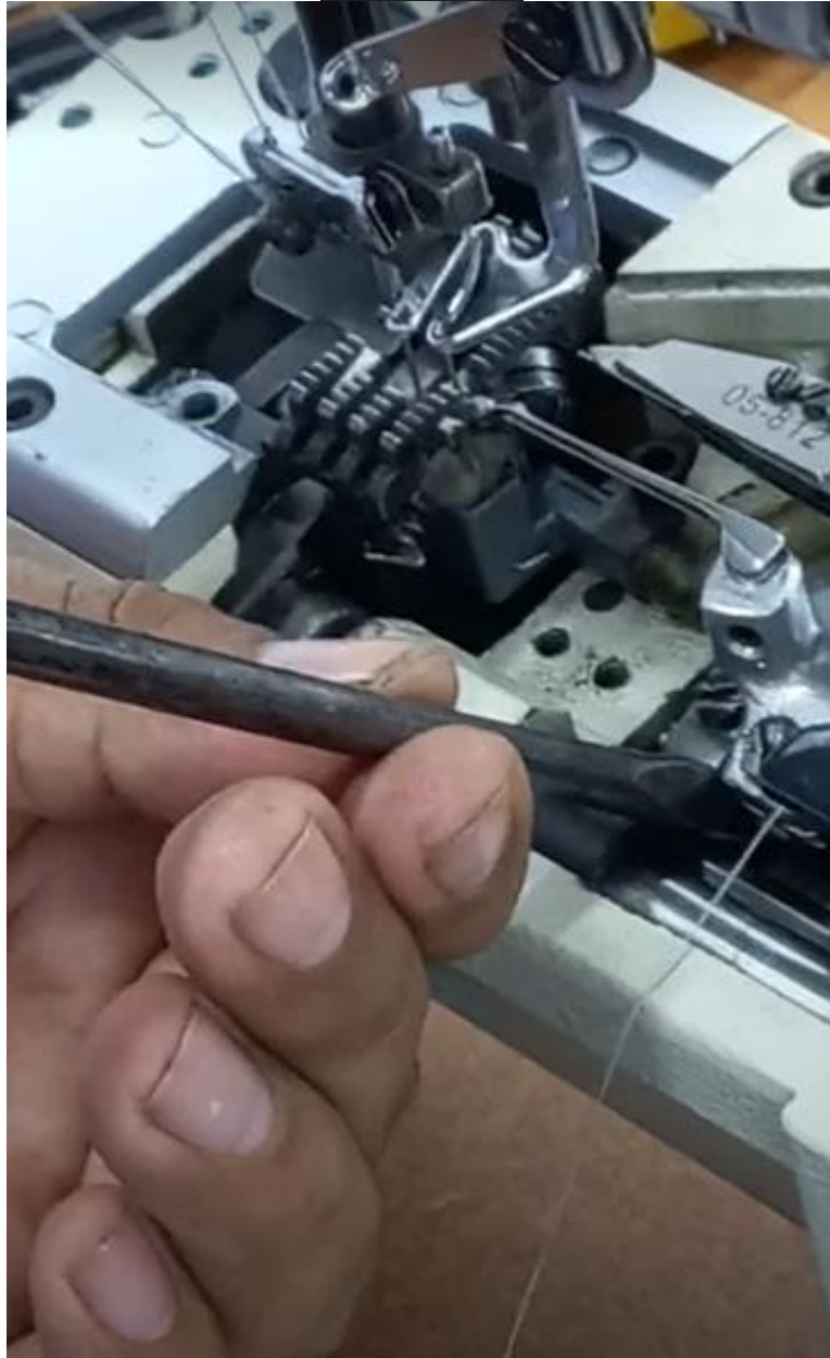
Regulación de crochet de collareta.
