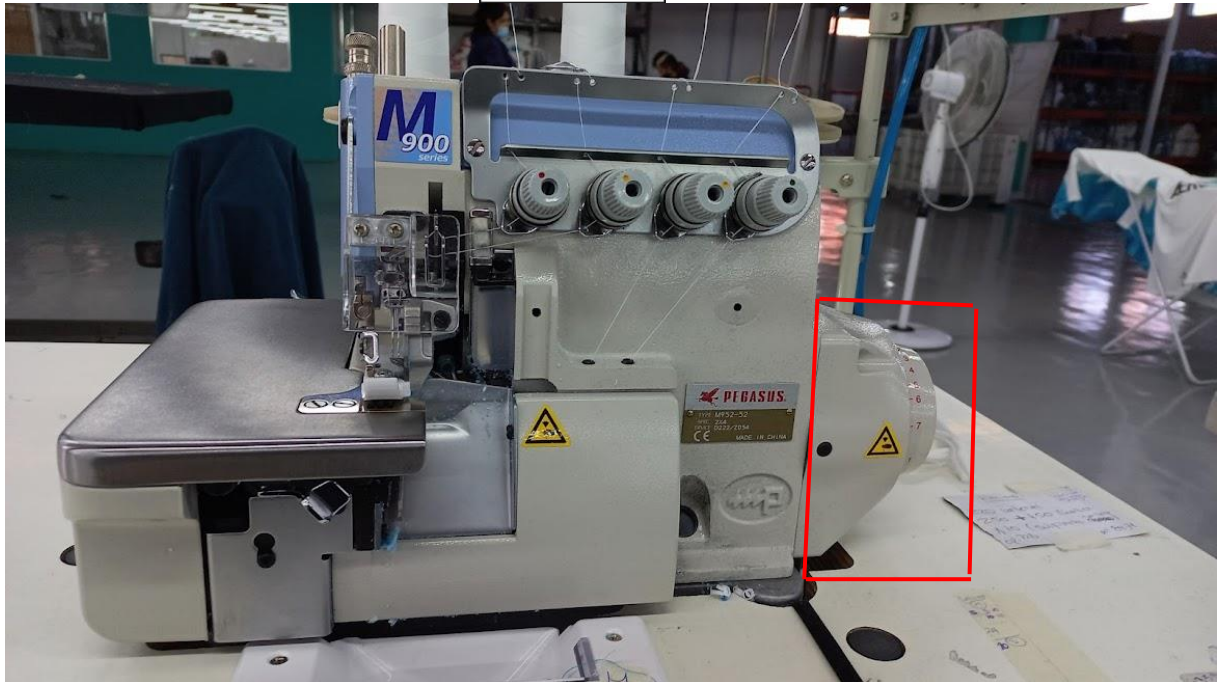
Pegasus M-900 sin motor eléctrico y sin correa.
