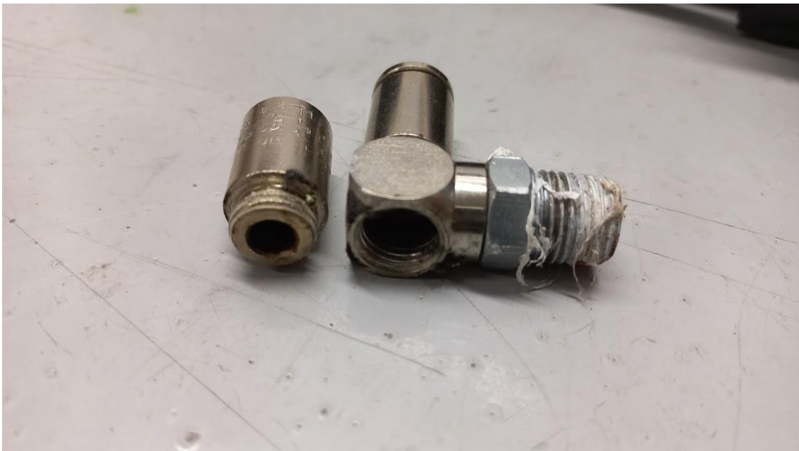
Tee con falla en uno de sus acoples.
