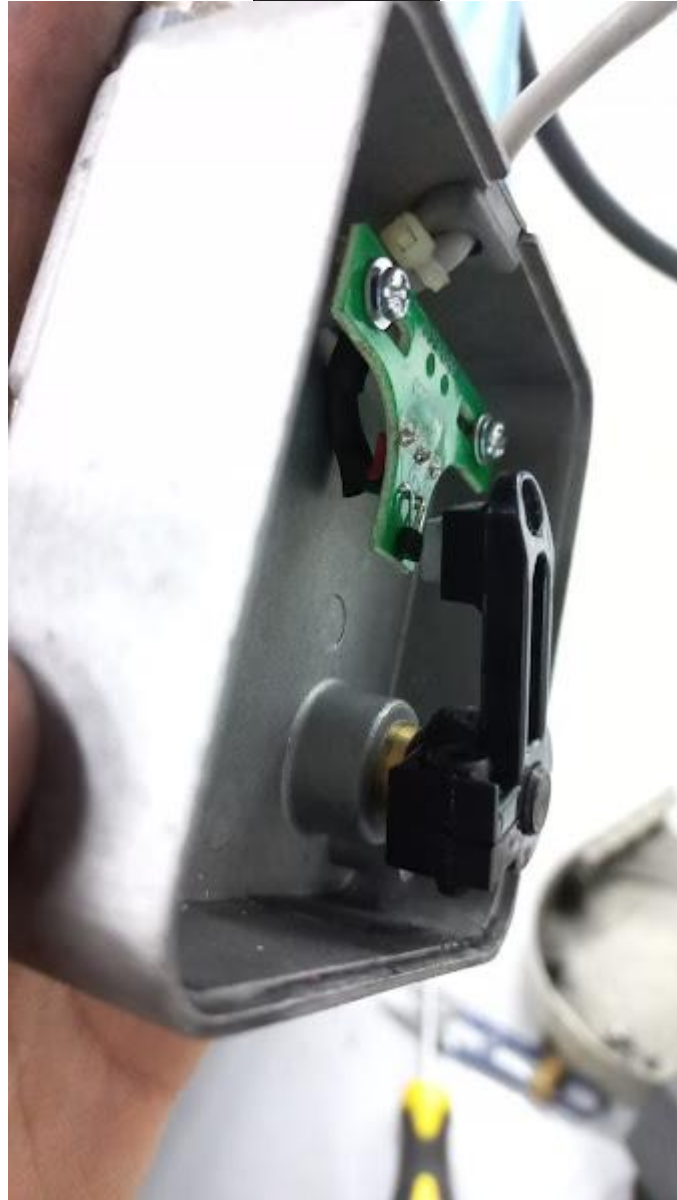
Plaqueta con sensor y brazo accionado por el pedal.
