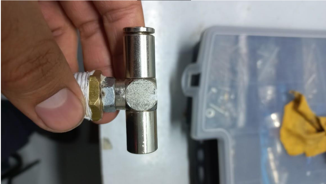
Tee con falla en uno de sus acoples.
