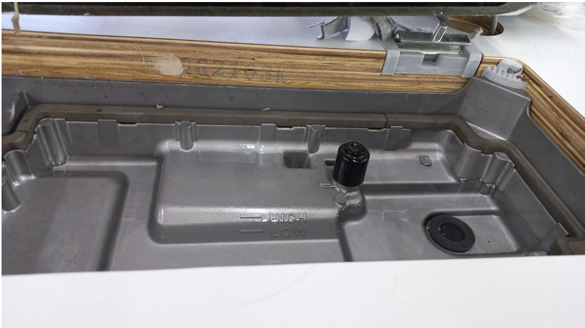
Nivel de aceite en máquina Recta.
