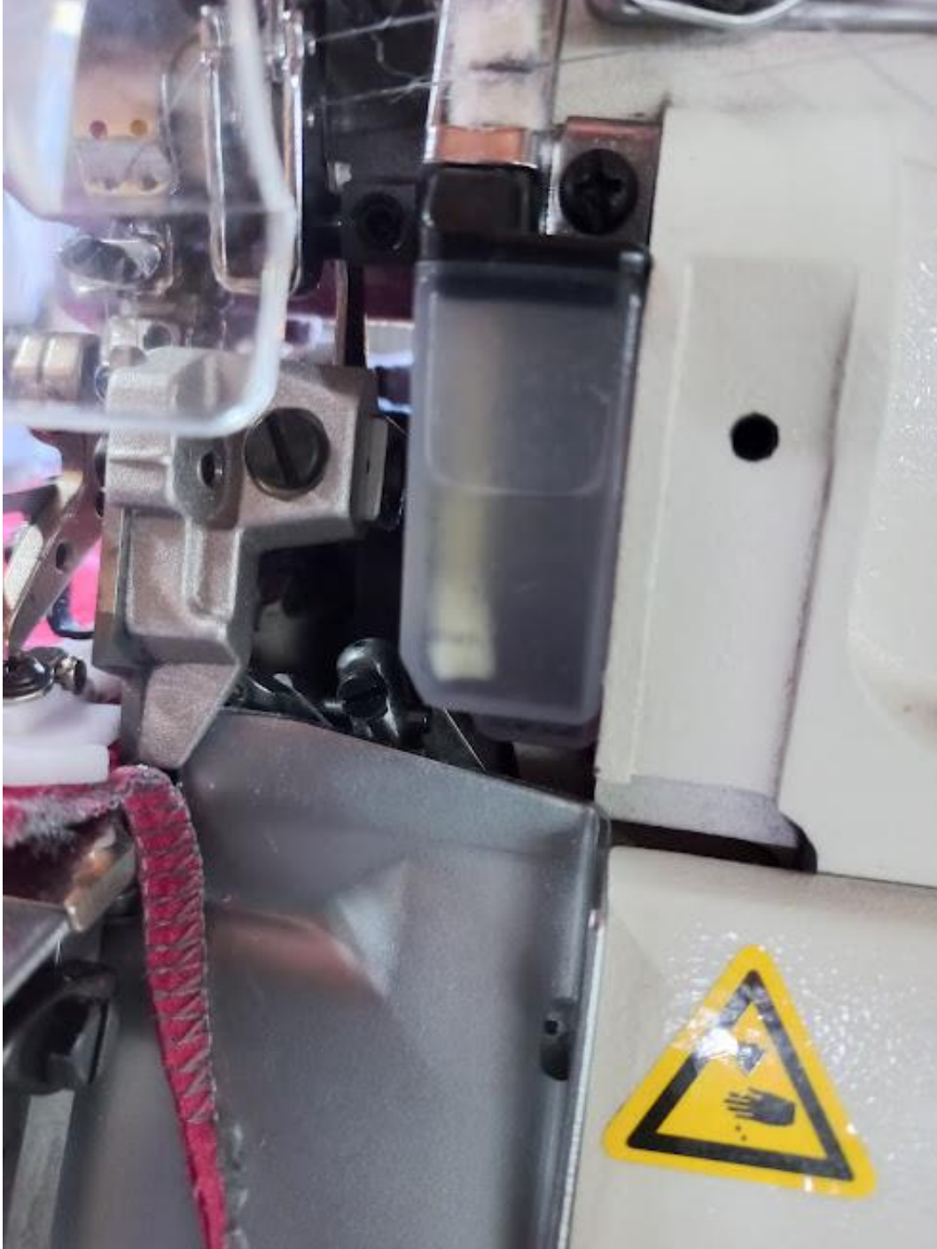
Recipiente de silicona en Overlock Pegasus M-900.
