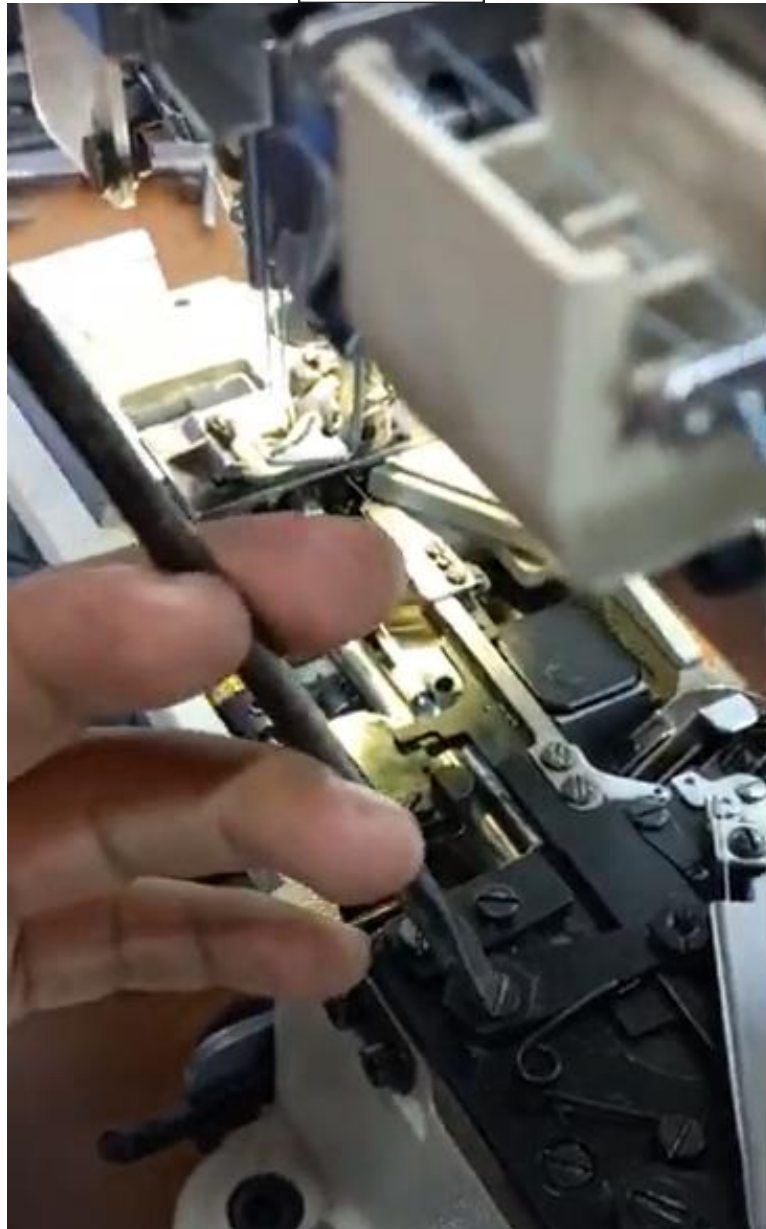
Regulación de ángulo de posición de cuchilla en collareta.
