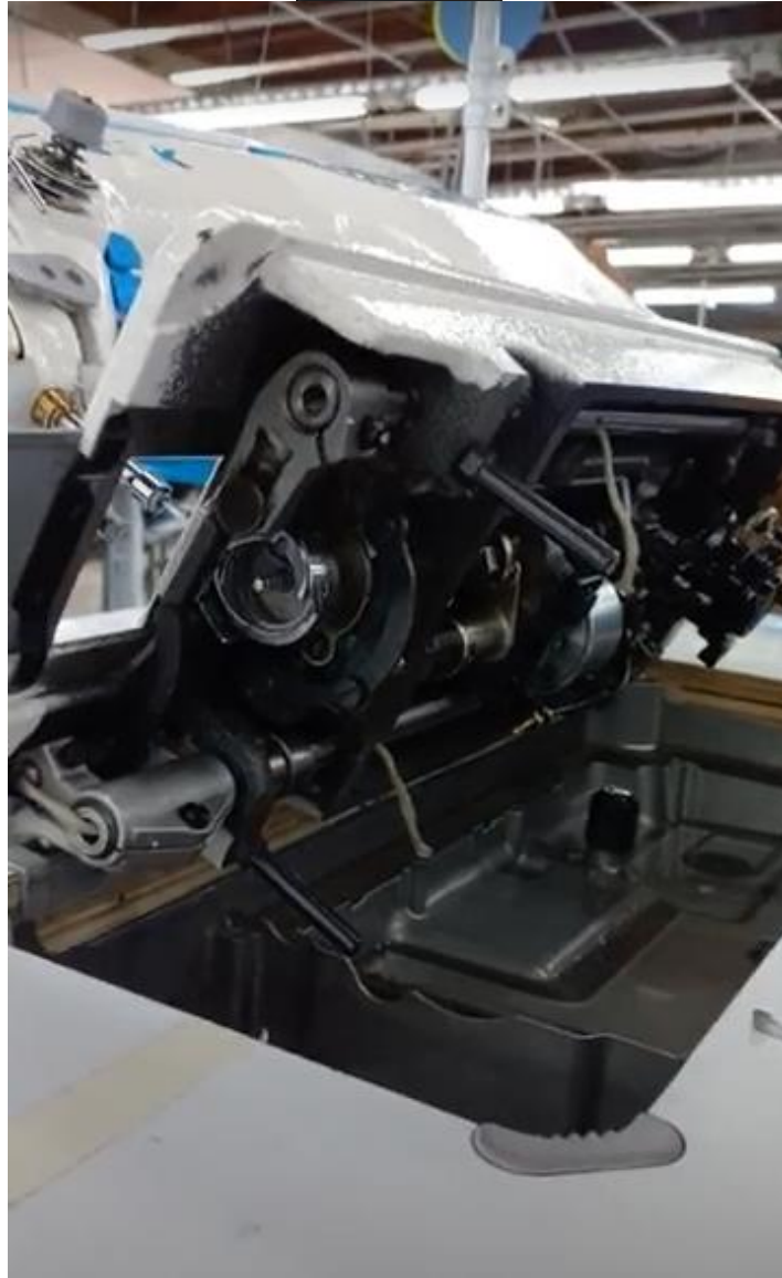
Regulación de distancia entre aguja y crochet de Recta.
