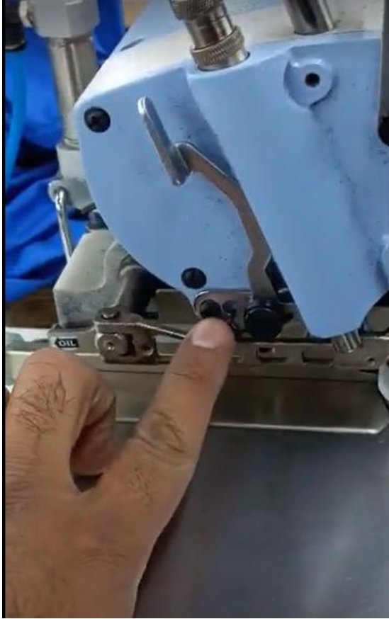
Regulación del tope de pie prensatela
