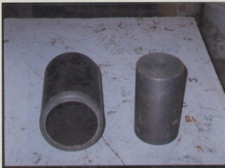
Fig. 7 Detalle de las piezas del sistema de desmolde de las probetas compactadas. Se observa el pie de apoyo y la camisa de extracción.
