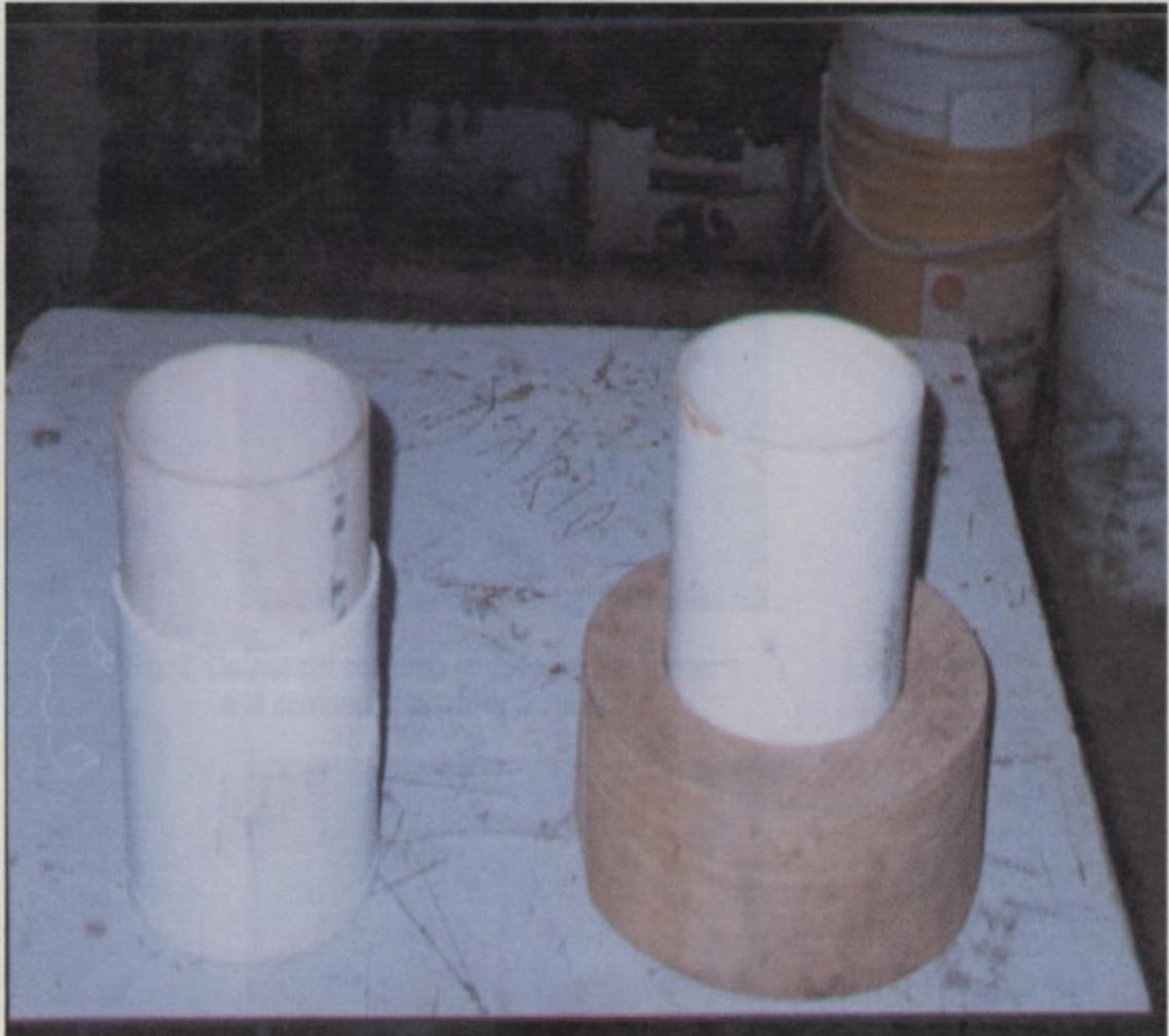
Fig. 1 Detalle del molde ubicado en base de compactación y prolongación para enrasar probetas.
