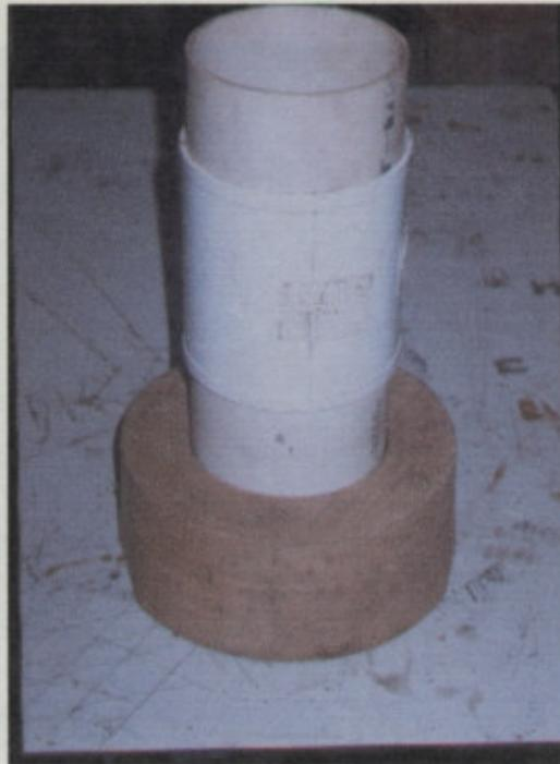
Fig. 2 Detalle del conjunto armado para proceder a la compactación de la probeta.
