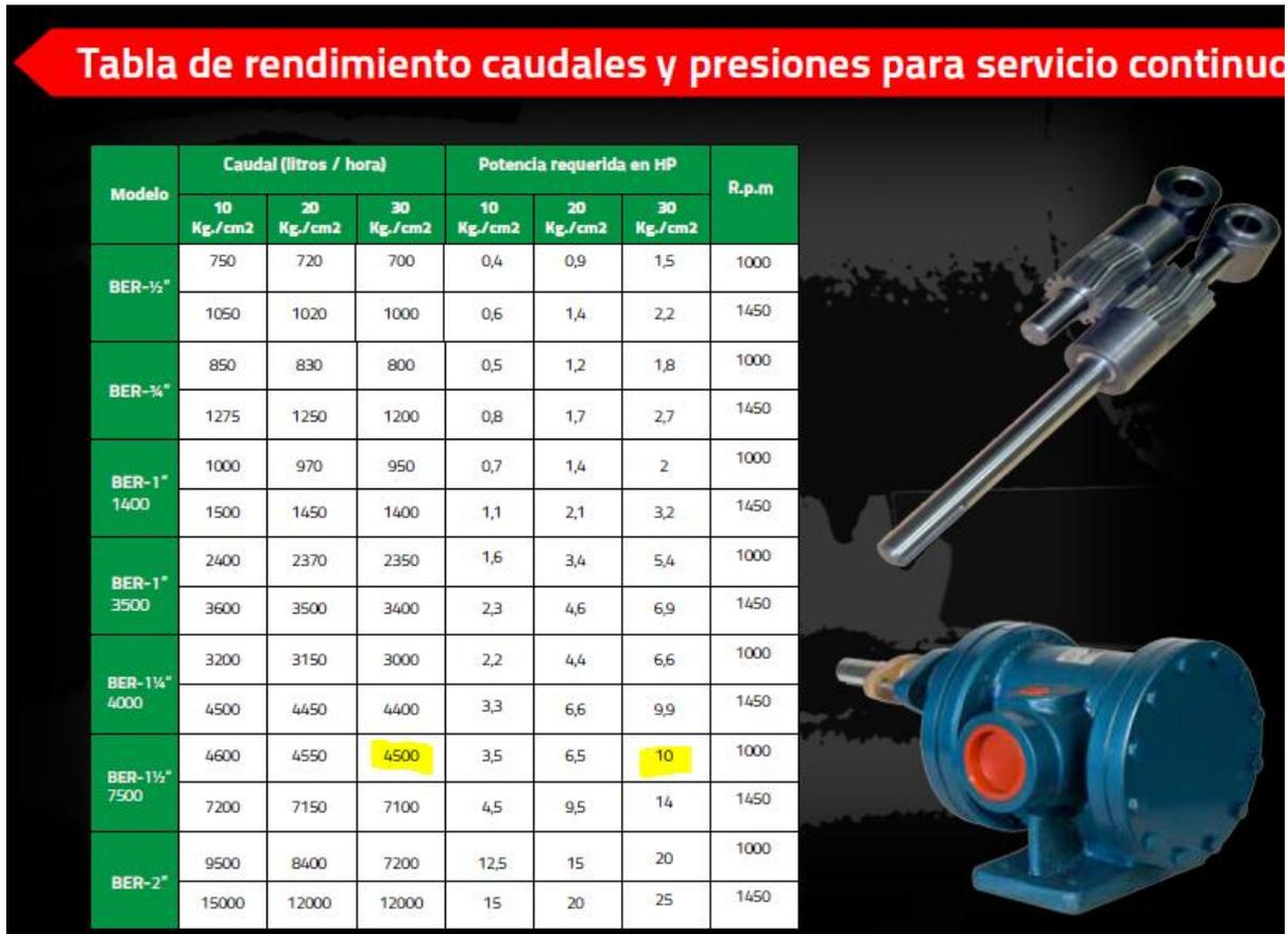
Fig. 4.15Tabla de rendimiento bomba a engranajes
