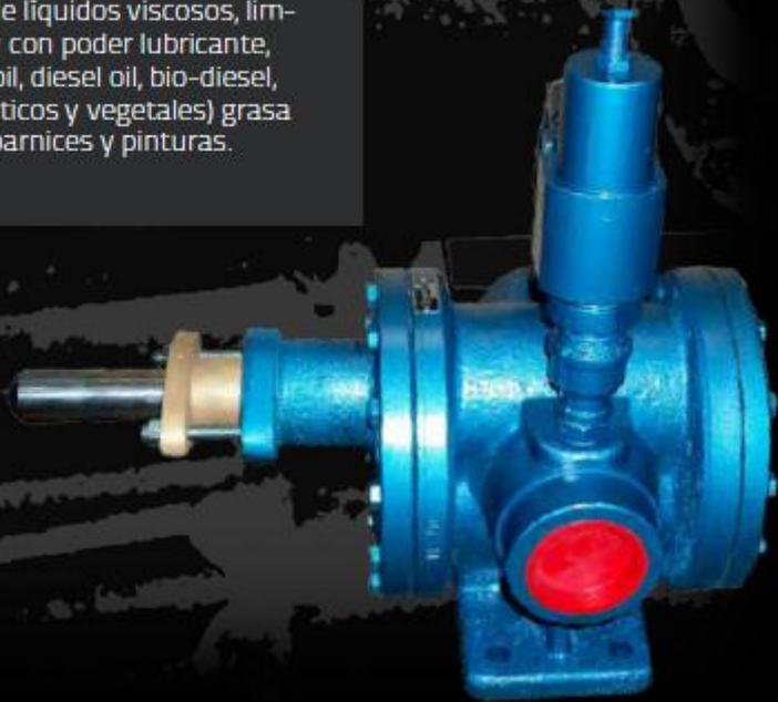
Las bombas MARZO rotativas a engranajes doble helicoidales línea BER, fueron diseñadas para trabajar en servicios muy exigentes en donde se requieren altas presiones de hasta 40 Kg./cm<sup>2</sup> y prolongada vida útil. Su construcción es robusta con cuerpos y tapas de buenos espesores, en fundición gris de grano fino, con interiores rectificadas.
