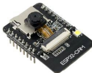
Imagen 5: Placa de desarrollo ESP32-CAM que incorpora una cámara para realizar detección de rostros
