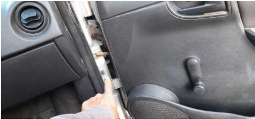
Sensor de apertura de puertas.
