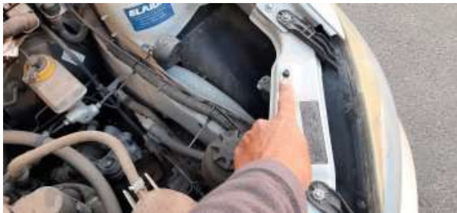
Sensor de apertura de capot.
