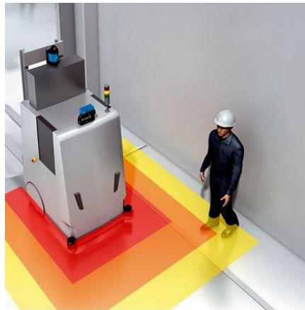
Figura 5. Detección de riesgo de colisión con el personal. Extraído de (Sick - Sensor Intelligence, n.d.)
