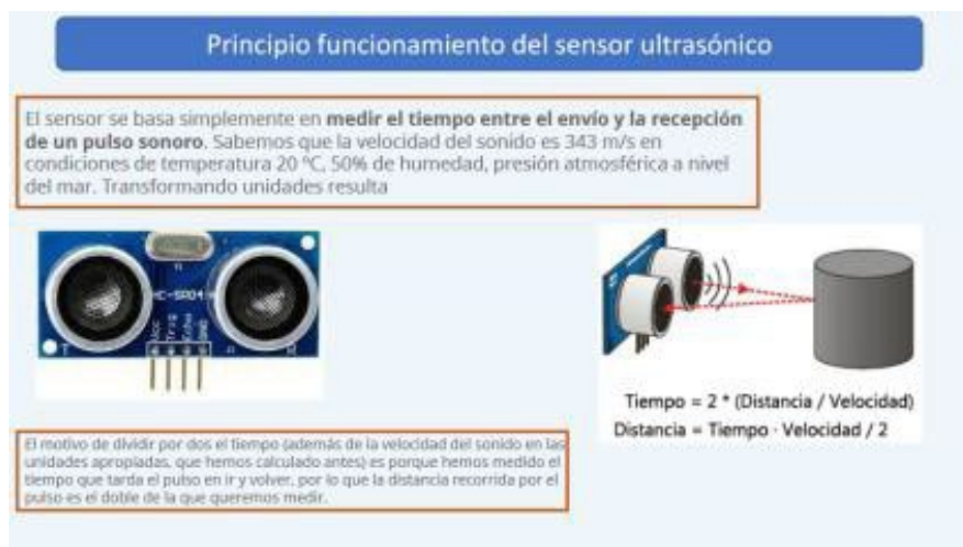
Imagen 1: Principio de funcionamiento del sensor
