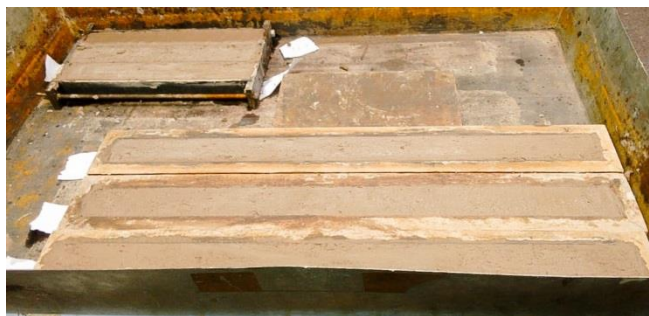
Figura 3: Moldeo de las probetas para el ensayo de retracción.
