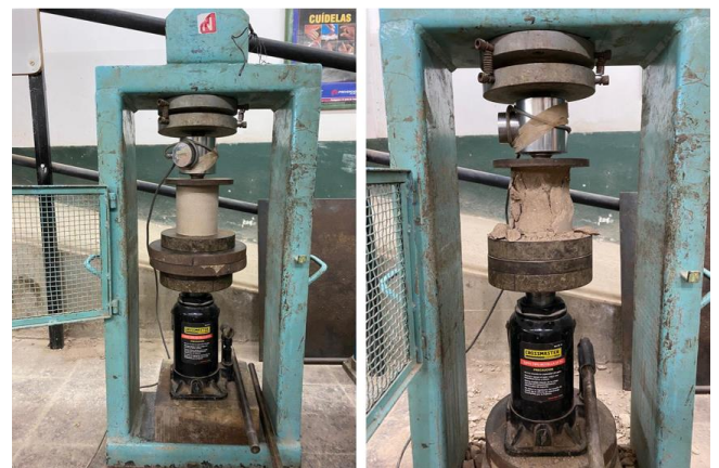
Figura 11: Realización del ensayo de resistencia a compresión sobre las probetas Proctor.
