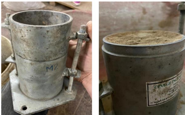
Figura 8: Preparación de probetas cilíndricas siguiendo la metodología “Proctor”.
