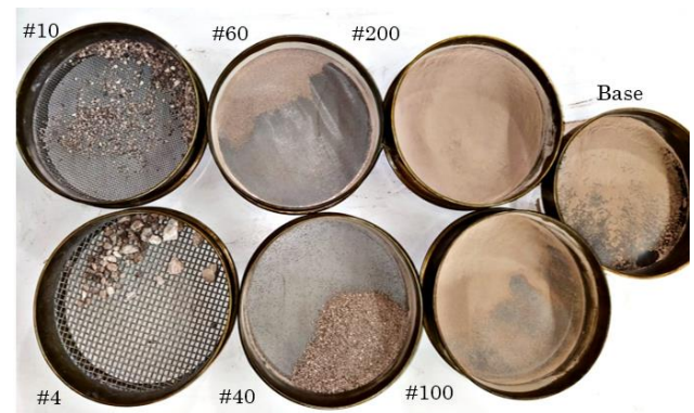
Figura 1: Distribución granulométrica aparente de la tierra.
