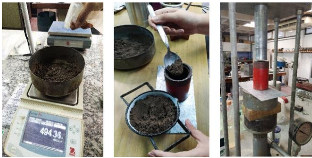
Figura 5: Proceso de moldeo de las probetas cilíndricas.
