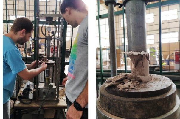
Figura 7: Realización del ensayo de resistencia a compresión sobre una probeta.
