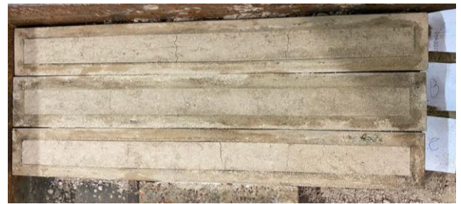
Figura 10: Retracción ocurrida en las probetas moldeadas según las dosificaciones A, B y C luego del proceso de curado y secado.
