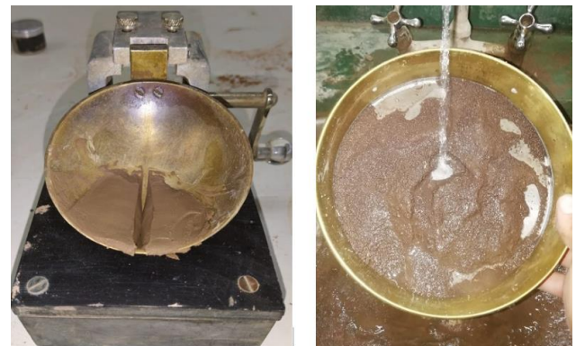
Figura 2: Determinación del Límite Líquido (izq) y pasante por el tamiz #200 (der).
