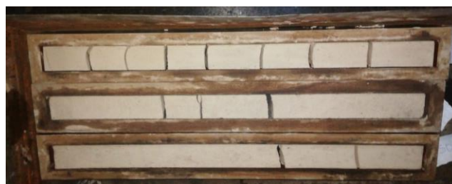
Figura 4: Retracción final en las probetas de 600 x 40 x 40 mm con 0% (arriba), 30% (centro) y 50% (abajo) de arena.
