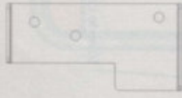
SopORTE del estribo izq. (vista frontal)
