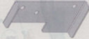
SopORTE del estribo izq. (vista isométrica)
