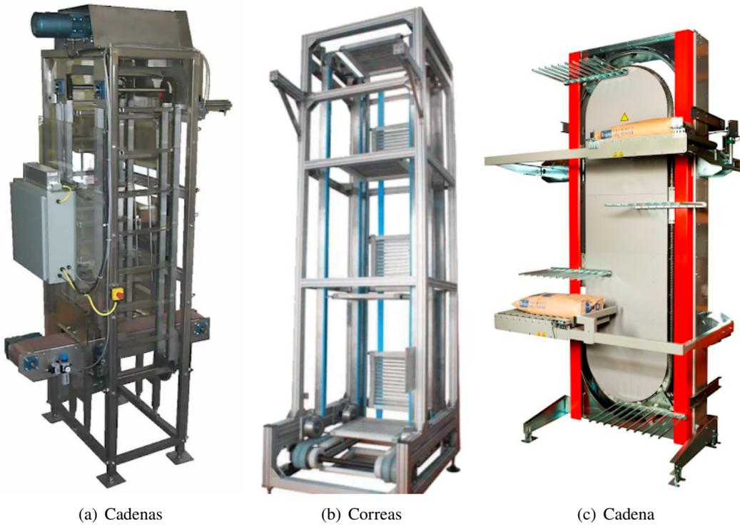
**Figura 1.4** Transportador vertical dinámico.
