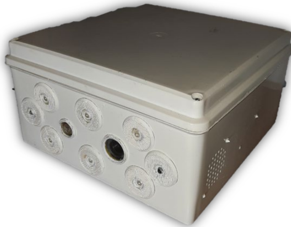
Figura 64. Gabinete de cámara trampa con conectores estancos, portaleds y porta cámara.
