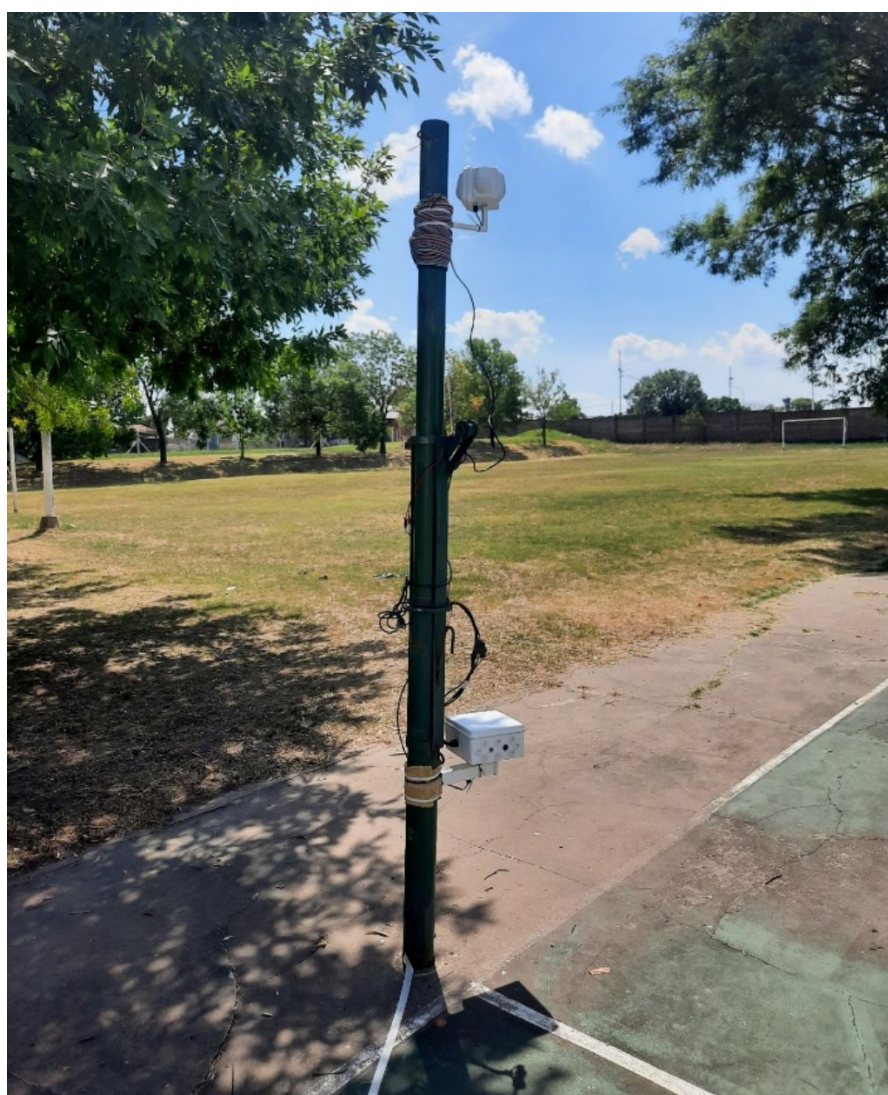
Figura 73. Sistema de cámara trampa, montado en poste.
