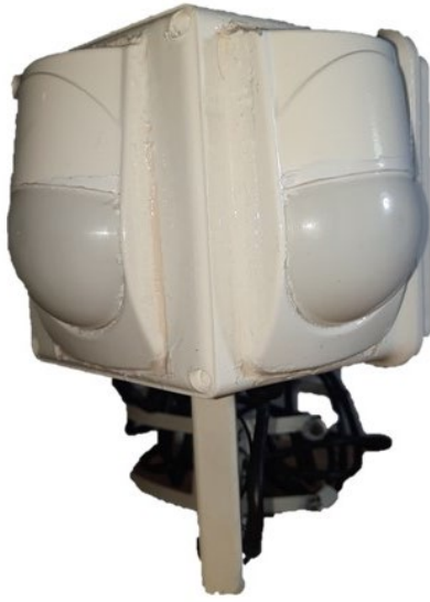
Figura 65. Gabinete de sensores PIR.
