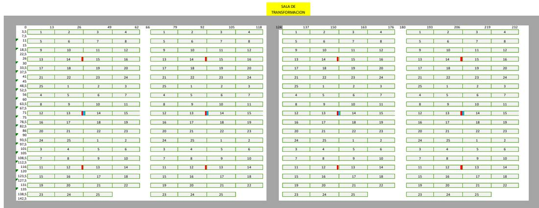
Una vez obtenida la matriz de paneles sobre la superficie utilizable, se procede a la disposición del cableado entre paneles para la conformación de las cadenas y su conexión a los inversores.
