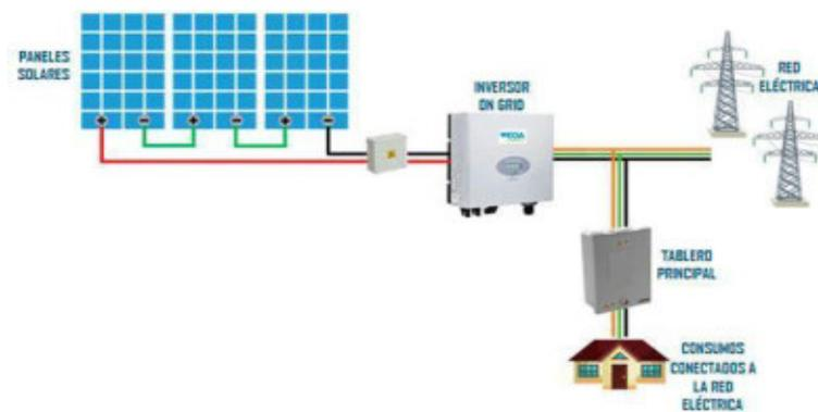
Figura 5.2.1. Esquema de un sistema fotovoltaico interconectado a la red sin almacenamiento de energía.
