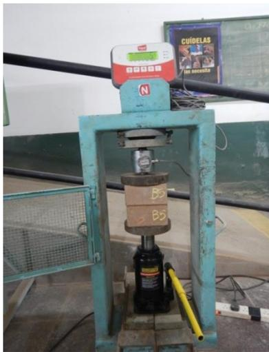
Figura 1: Ensayo de resistencia a compresión
