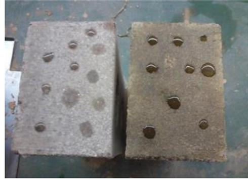
Figura 7: Análisis comparativo del efecto hidrófugo del recubrimiento sobre dos BTCs
