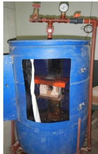
Figura 2: Determinación del nivel de resistencia a la erosión húmeda por chorro de agua
