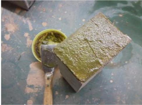
Figura 6: Recubrimiento de un BTC con "pasta de camalote"
