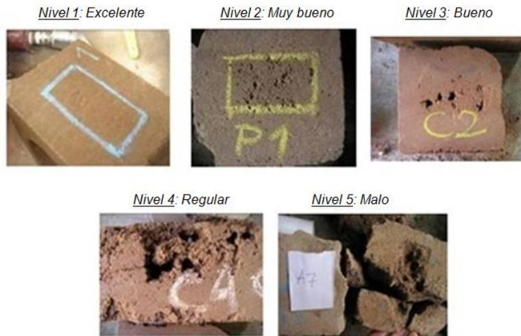
Figura 8: Patrones de comparación desarrollados para determinar el nivel de resistencia a la erosión húmeda de los BTCs.
