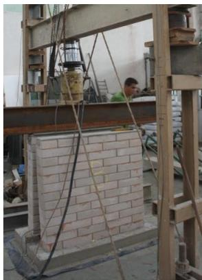
Figura 4. Ensayo de compresión sobre un muro de BTC
