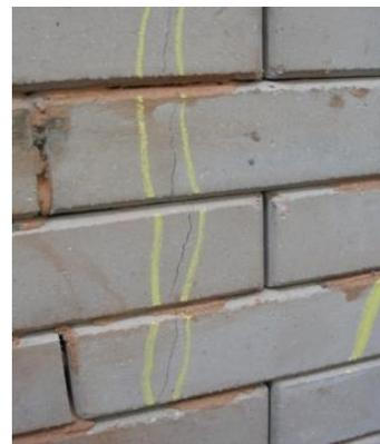
Figura 5. Patrón de figuración del muro bajo cargas
