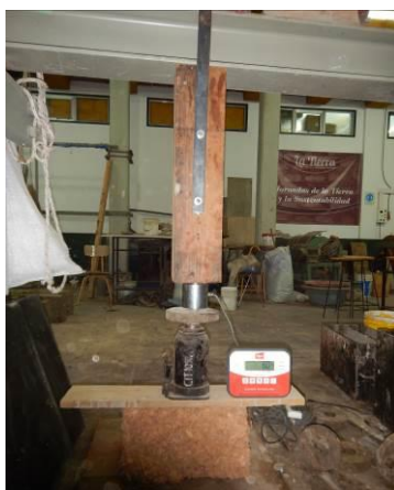
Figura 4. Ensayo de compresión de un bloque de tierra alivianada (BTA)
