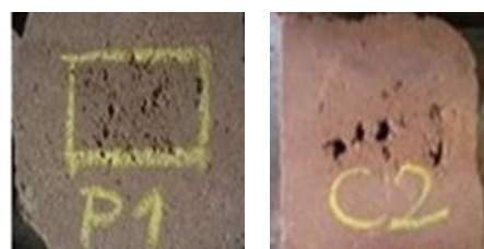
Figura 10. BTC ensayados a erosión
