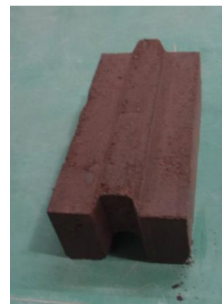
Figura 7: fotografía de un BTC producido por la prensa electromecánica
