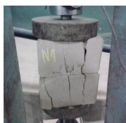
Figura 9. BTC ensayado a compresión
