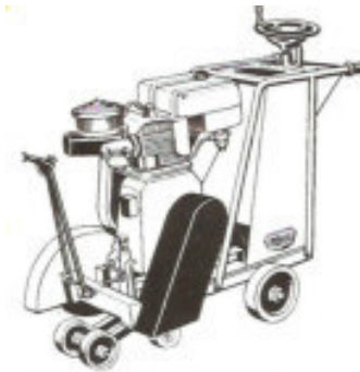
ASERRADORA DE JUNTAS PARA PAVIMENTOS DE HORMIGÓN Y ASFALTO Modelo AJ-85 equipada con motor a explosión, diseñada para trabajar con disco de sílice de acero con inserciones de pastillas de diamante industrial de hasta 14" (355 mm), profundidad de corte máxima 110 mm. (opcional con motor eléctrico)
