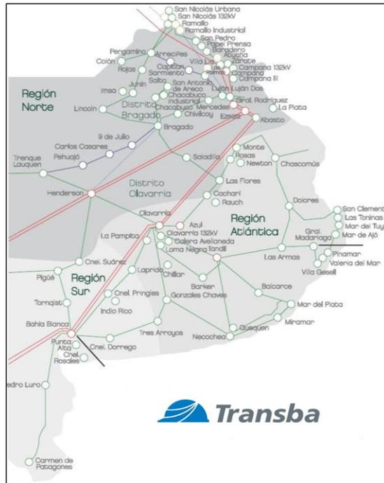
**Figura 4:** Esquema geográfico Red de Transporte 132 kV operada y mantenida por TRANSBA S.A.
