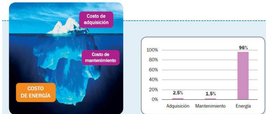
**Figura 27:** Representación de costos en la vida útil de un motor (izquierda) y representación de costos en la vida útil de un motor (derecha)
