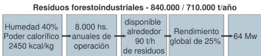
**Figura 15:** Diagrama de producción de energía eléctrica mediante residuos forestales
