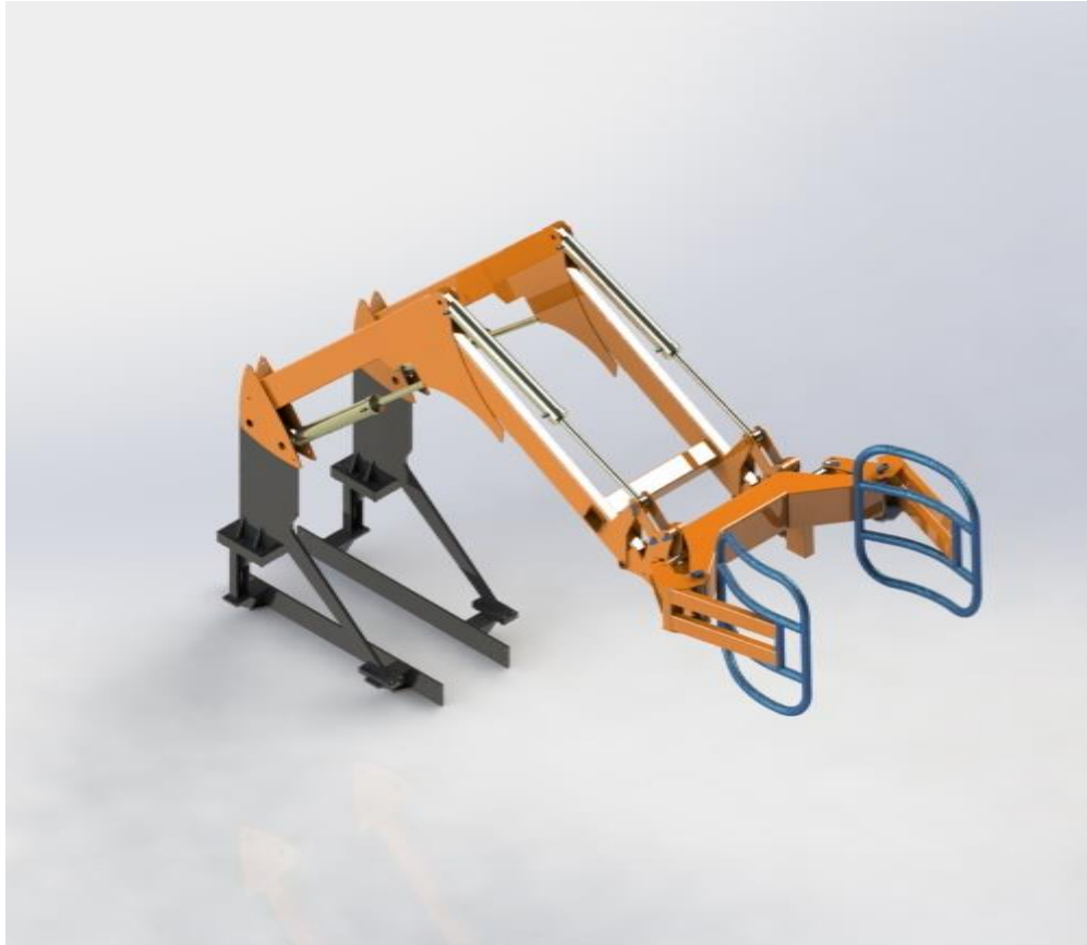
Imagen 114. Manipulador frontal. Diseño en SolidWorks
