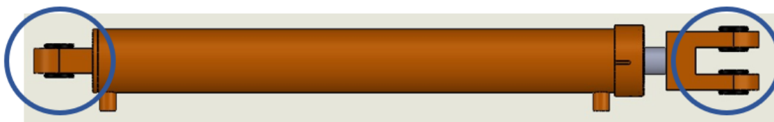
Imagen 81. Anclajes de rótula (izq.) y horquilla (der.)
