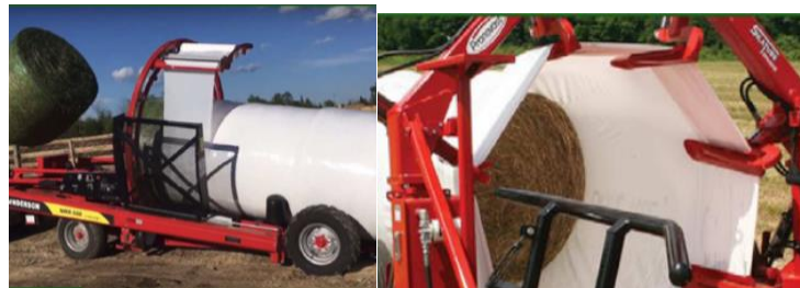
Imagen 13. Vista de la máquina para las líneas de rollos. Vista de las uñas que sujetan el film.
