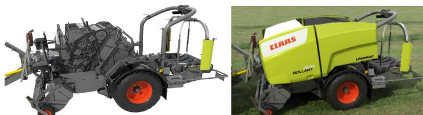
Imagen 10. Rotoenfardadora-empaquetadora Claas Rolant.
