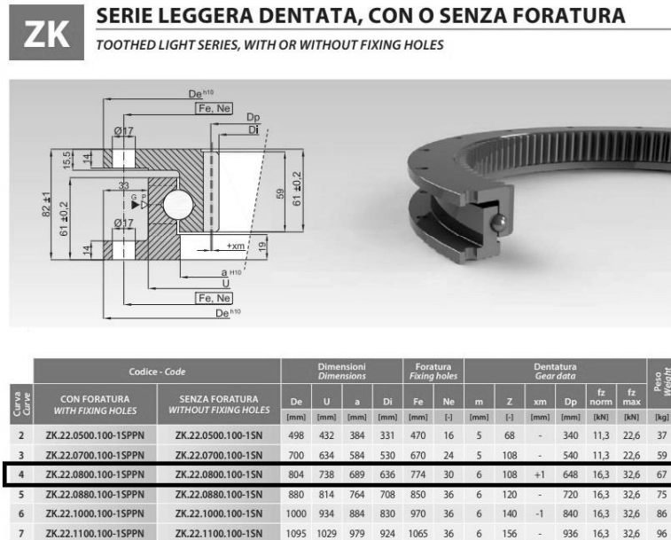
Imagen 55. Aro giratorio seleccionado, cortesía de ISB-Industries
