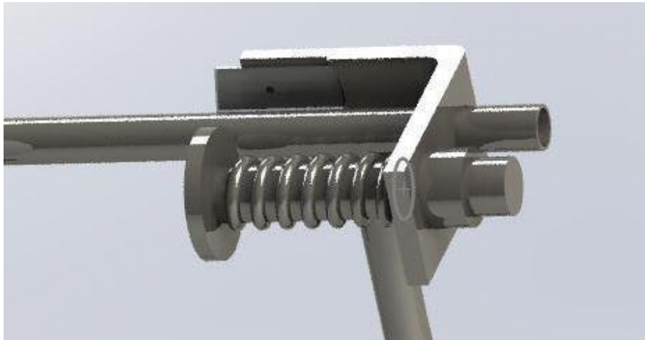
Imagen 93. Resorte y cuchilla del sistema de corte y retención
