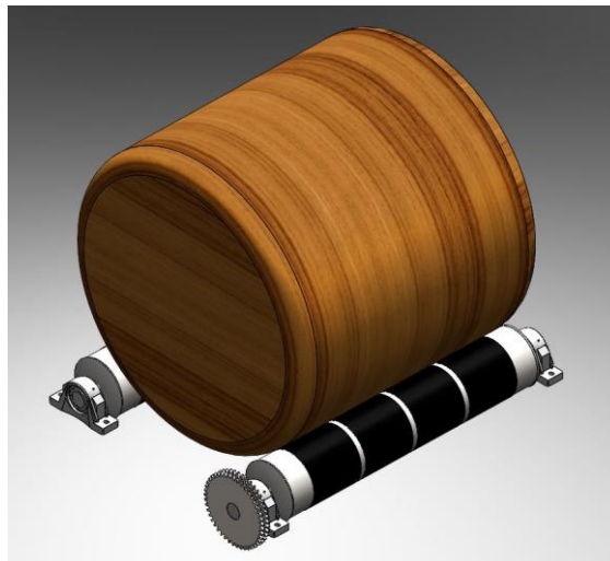
Imagen 50. Rollo de alfalfa sobre los rodillos de la mesa empaquetadora. Se observa el sentido de giro en cada eje y los torques descritos.
