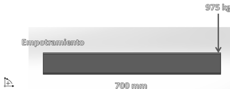
Imagen 125. Para la viga rigidizadora se consideró empotrada en un extremo con una carga igual a \frac{3}{4} de la total.
