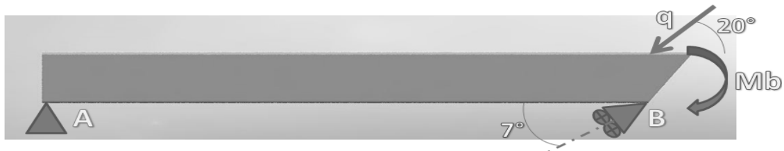
Imagen 123. Viga 1 al ser girada 70^\circ para ser analizada como una viga completamente horizontal.
