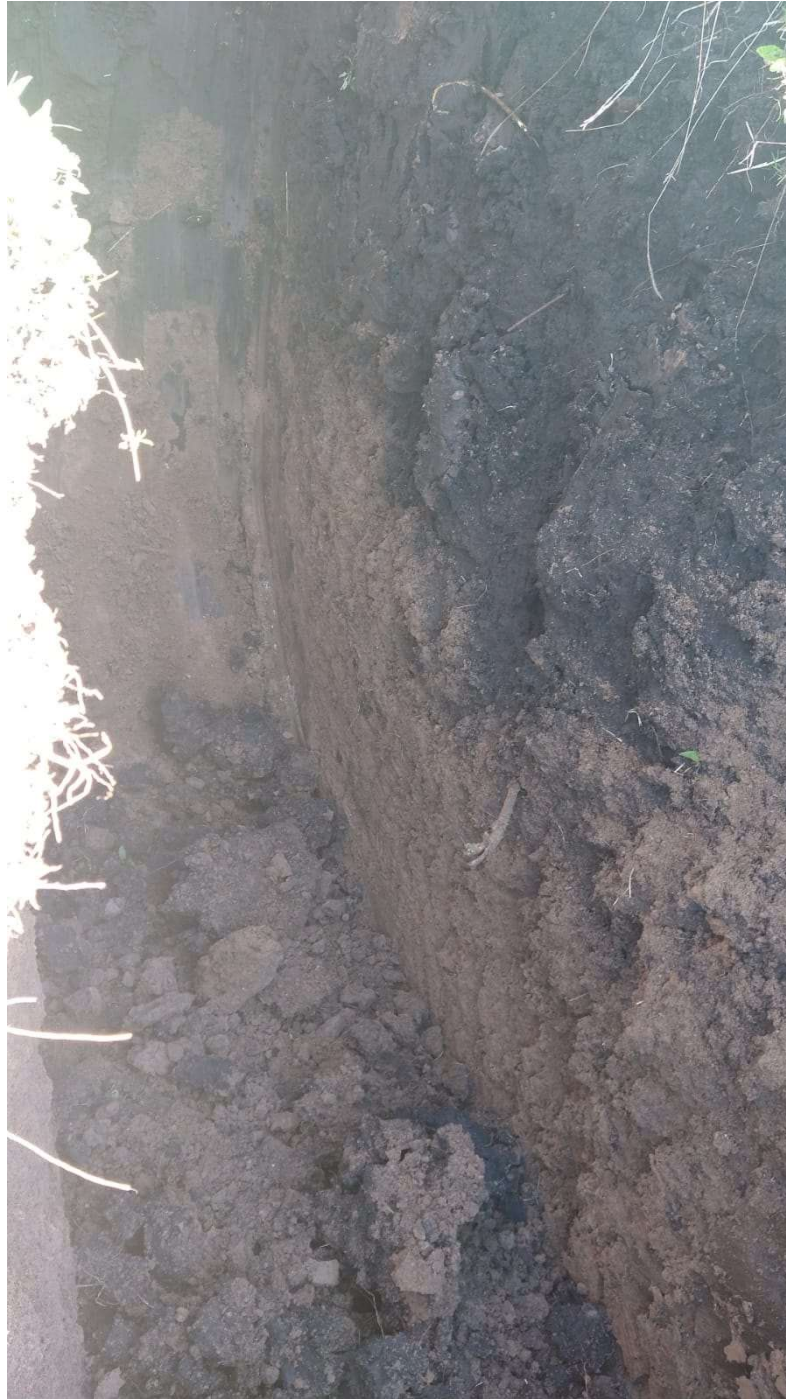
Figura 44| Perfil estratigráfico inalterado del primer punto de cateo. Elaboración propia
