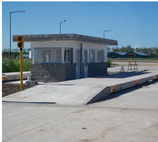
Figura 156| Balanza de pesaje de camiones tipo con garita estilo ejemplo. Fuente: https://www.sipel.com.ar/es/producto/balanza-de-camiones
