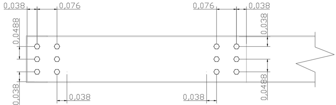
Figura 261| Esquema de la unión abulonada pilar – dintel, vista de arriba, dimensiones en m. Fuente: Elaboración propia.
