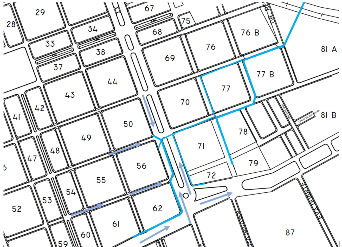
Figura 17| Diagrama de funcionamiento de la cuenca sur, correspondiente a la primera etapa del plan desarrollado posteriormente
