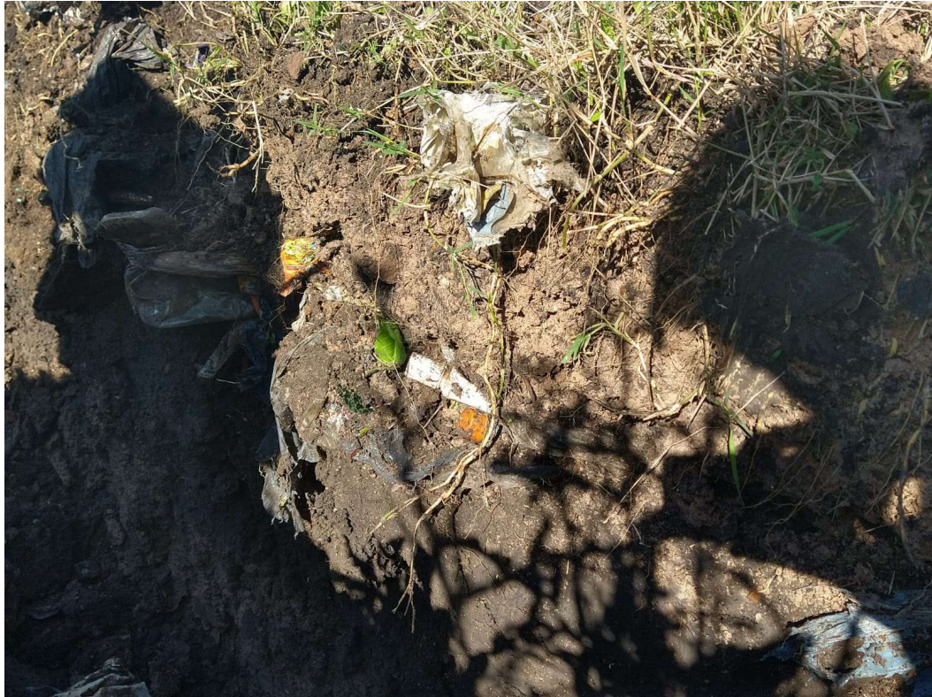
Figura 50| Estratigrafía del lugar, con aproximadamente los primeros 50 cm con residuos intermedios y suelo mezcla. Elaboración propia
