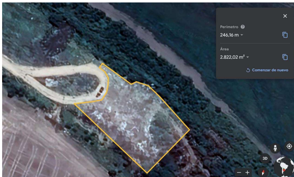
Figura 112| Última área de disposición de residuos, al lado del camino de la rotonda nueva. Área de residuos: 2825 m 2 , con una altura promedio de 0,7m. Fuente: Google Earth Pro y elaboración propia.
