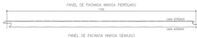
Figura 194| Panel de fachada según fabricante. Fuente: https://www.hiansa.com/wp-content/uploads/2020/11/HIANSA-PANEL-FACHADA-ficha-producto.pdf
