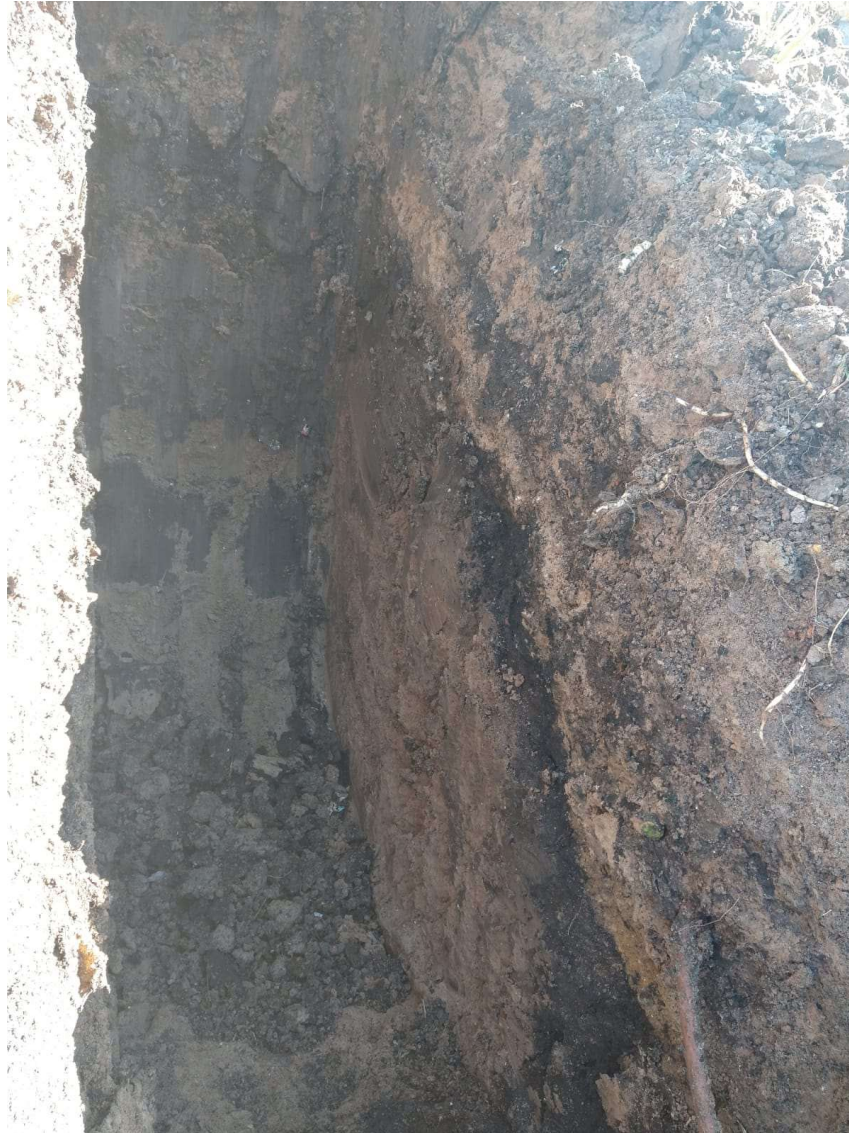
Figura 46| Perfil estratigráfico de la segunda calicata, donde el suelo se encuentra alterado por la remoción de suelo y excavaciones. Elaboración propia
