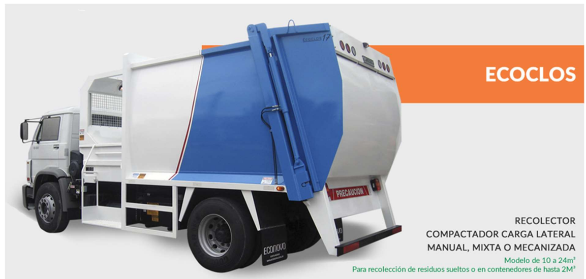
Figura 120| Modelo de recolector compactador de carga lateral, de la compañía Econovo, modelo Ecoclos. Fuente: https://www.econovo.com.ar/portfolio-view/ecoclos/
