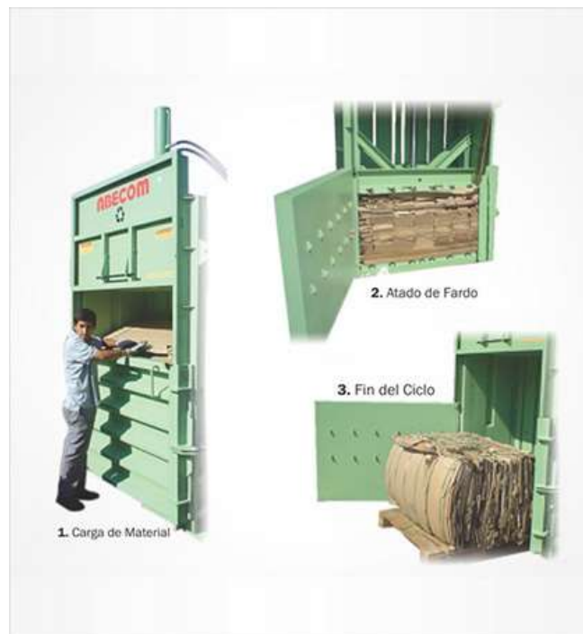
Figura 61| Secuencia de operación recomendada del fabricante. Fuente: https://www.abyper.com.ar/assets/img/productos/abecom/compactadoras_enfardadoras_verticales_EV/2.jpg
