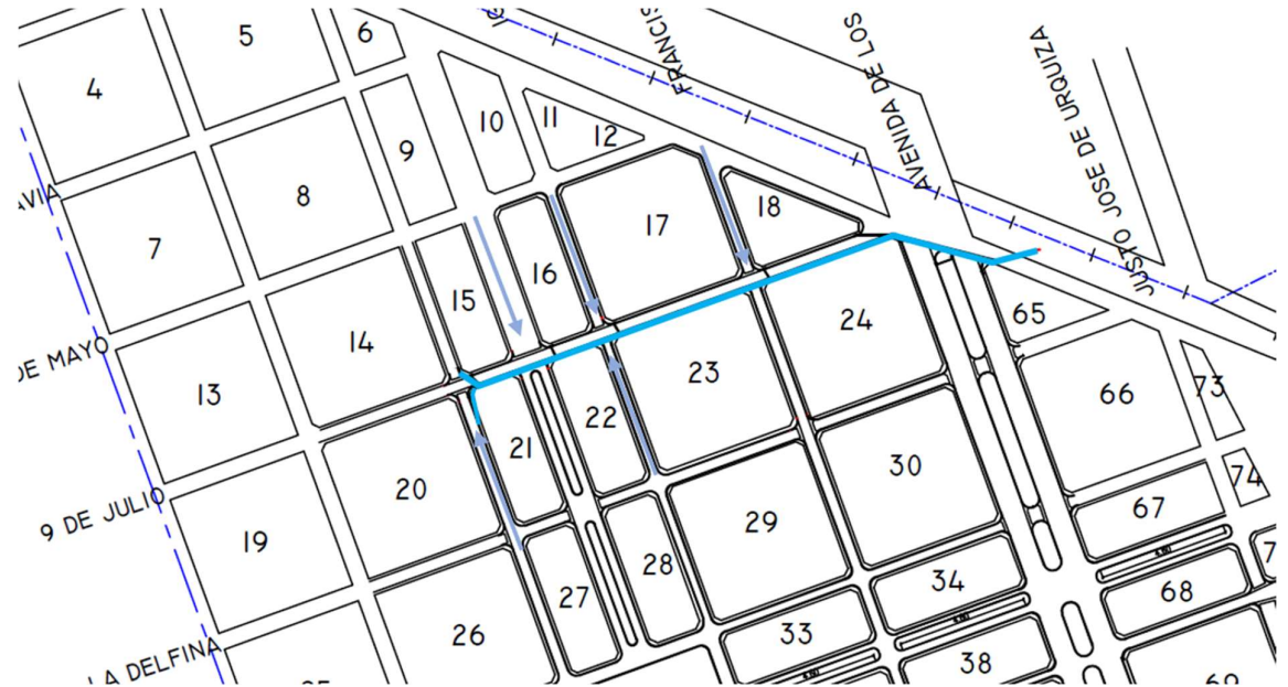
Figura 18| Diagrama de funcionamiento de la cuenca norte, de menor tamaño de la cuenca sur, con gráfico de la escorrentía de las aguas y trazado de los caños subterráneos.
