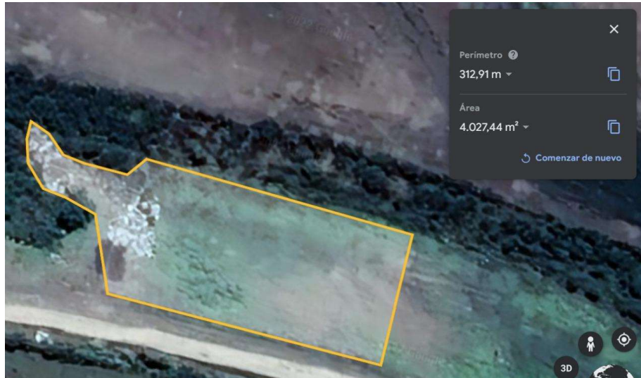
Figura 111| Área de residuos que antes ha sido limpiada donde se encontraba el terreno libre. Área de residuos: 4030 m 2 , con una altura promedio de 0,4m. Fuente: Google Earth Pro y elaboración propia.
