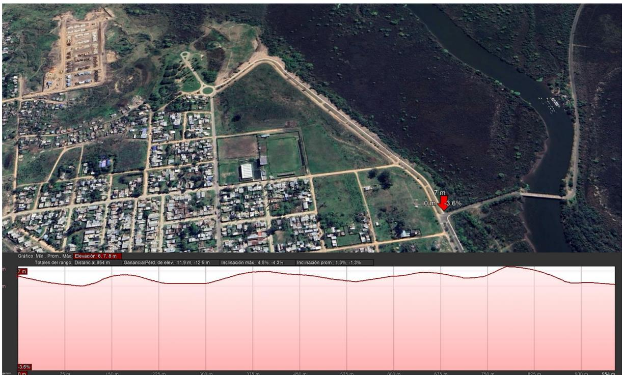
Figura 5.94 Anteproyecto vial: altimetría del trazado actual Av. Esilda Tavella.
