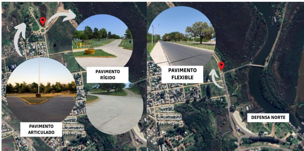
Figura 5.117 Anteproyecto vial: sistemas de pavimentos a extremos de la vía estudiada.
