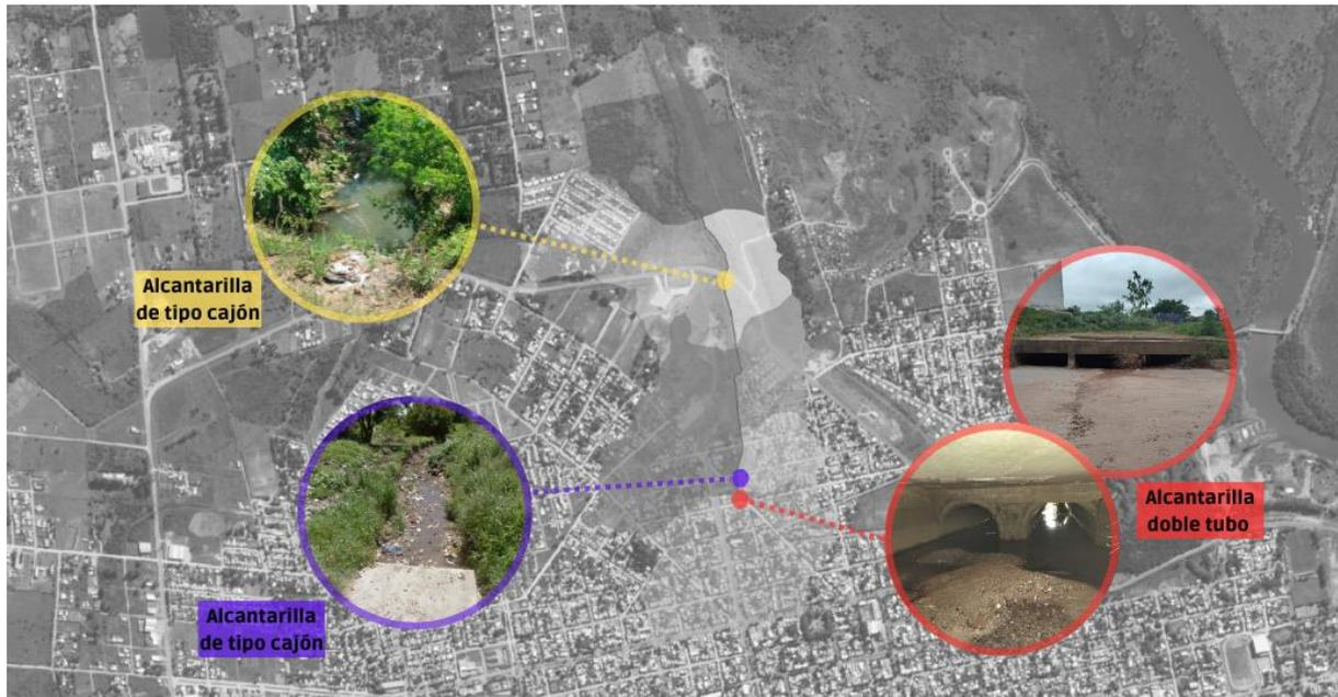
Figura 5.83 Anteproyecto hidráulico: alcantarillas existentes.
