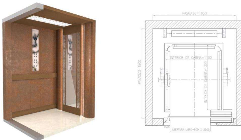
Figura 5.62 Anteproyecto arquitectónico: ascensor electromecánico.
