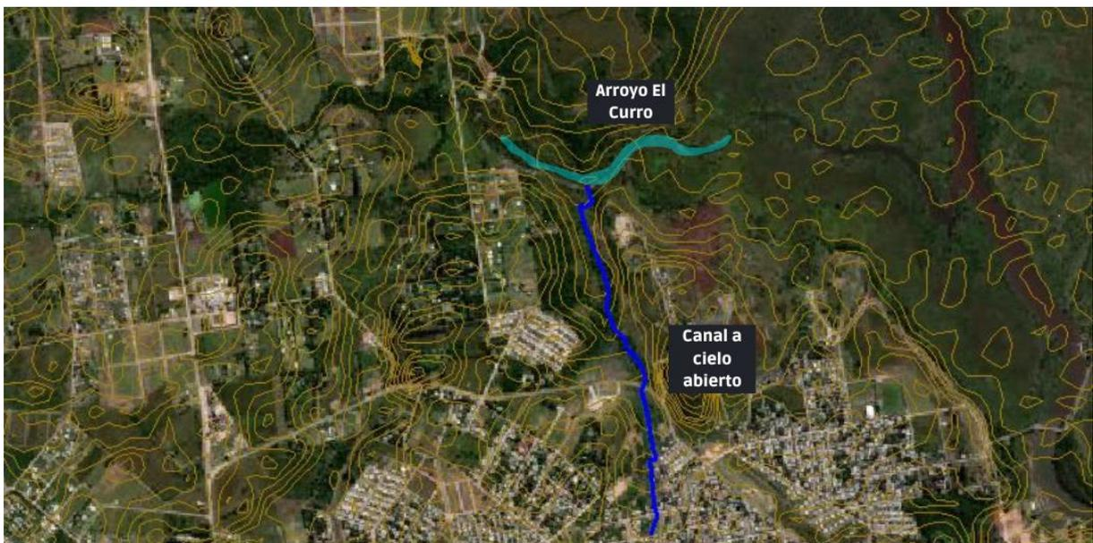
Figura 5.74 Anteproyecto hidráulico: curvas de nivel canal a cielo abierto – Cuenca Mosconi.
