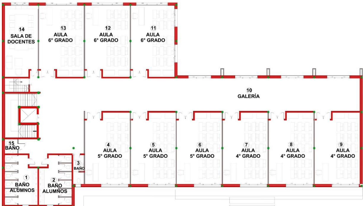
Figura 5.28 Anteproyecto arquitectónico: edificio nuevo – segundo piso.
