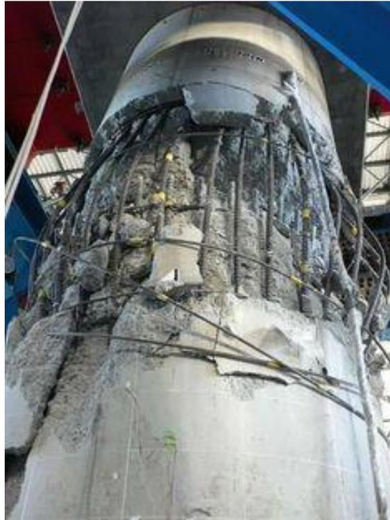
Pandeo por exceso de carga sobre una columna de hormigón armado.
