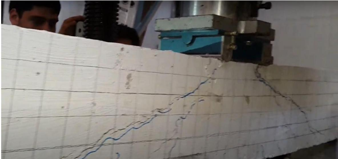
Ensayo de fractura por corte
