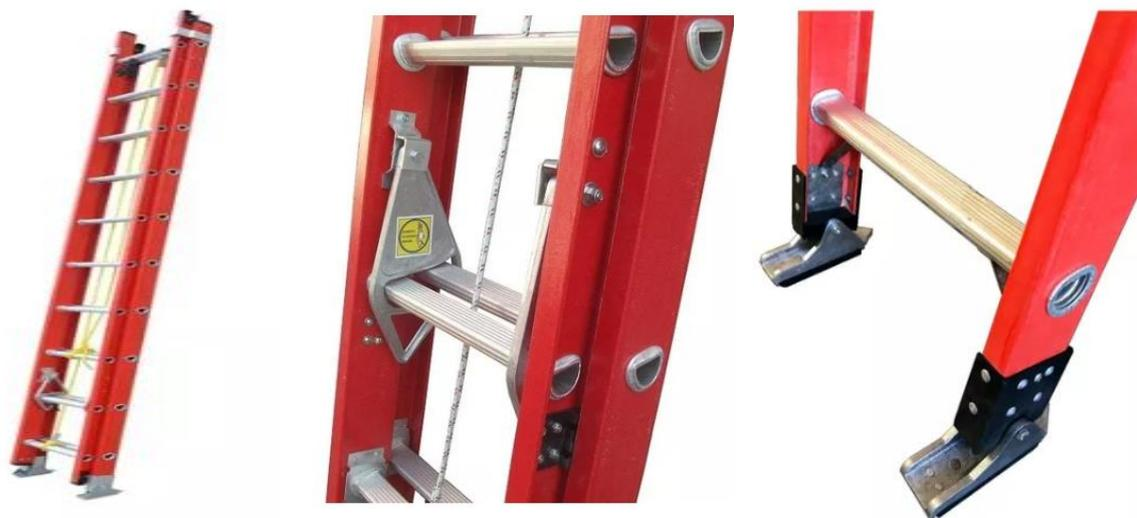
Existen modelos de largueros de fibra de vidrio y peldaños de aluminio, extensibles a diferentes longitudes, que son las preferidas en el ámbito de la distribución de energía y las telecomunicaciones debido a su bajo peso, diseño extensible y buena resistencia mecánica al traslado y uso. Muchos modelos incorporan ciertas capacidades dieléctricas o parcialmente aislantes, lo que las hace de uso preferencial en tareas con riesgo de choque eléctrico.
