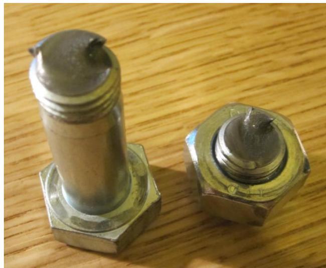
Ejemplo de esfuerzo por torsión (izq), bulón cortado por esfuerzo de torsión (derecha)
