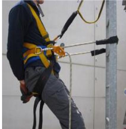
**Salvacaídas deslizante tipo T4:** Es un dispositivo con función de bloqueo automático y sistema de guía. El dispositivo se desplaza a lo largo de una línea de anclaje o línea de vida vertical (soga o cable) que se extiende a lo largo de la zona de trabajo acompañando al usuario sin requerir intervención manual durante los cambios de posición hacia arriba o hacia abajo y se bloquea automáticamente sobre la línea de anclaje cuando se produce una caída.
