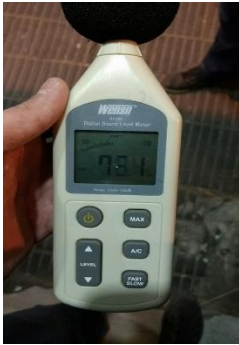
Medición realizada en las puertas de acceso. Valor: 78.4 dB
