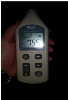
Medición realizada en el área externa (patio). Valor: 75.5 dB
