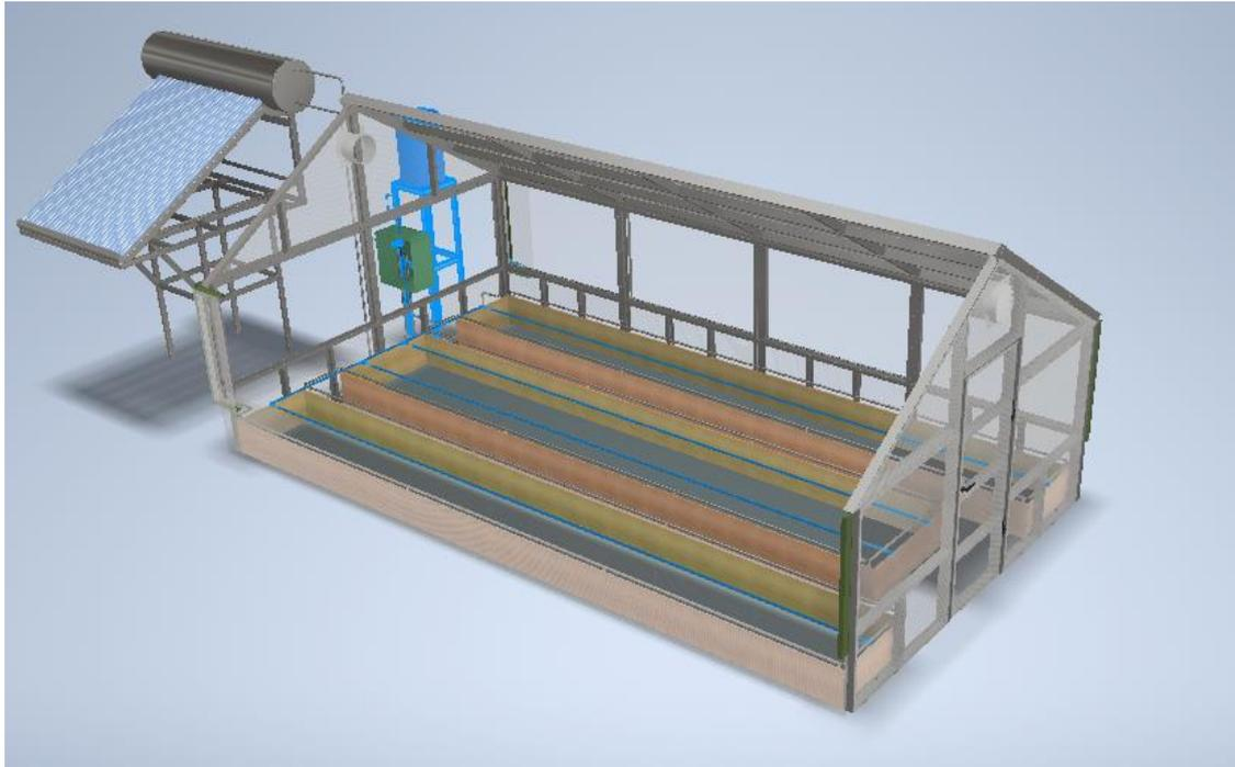
El sistema de riego por goteo, funciona por gravedad y es activado por una electroválvula. Dicho sistema se puede modificar manualmente, dependiendo de qué cantero se desee regar.
