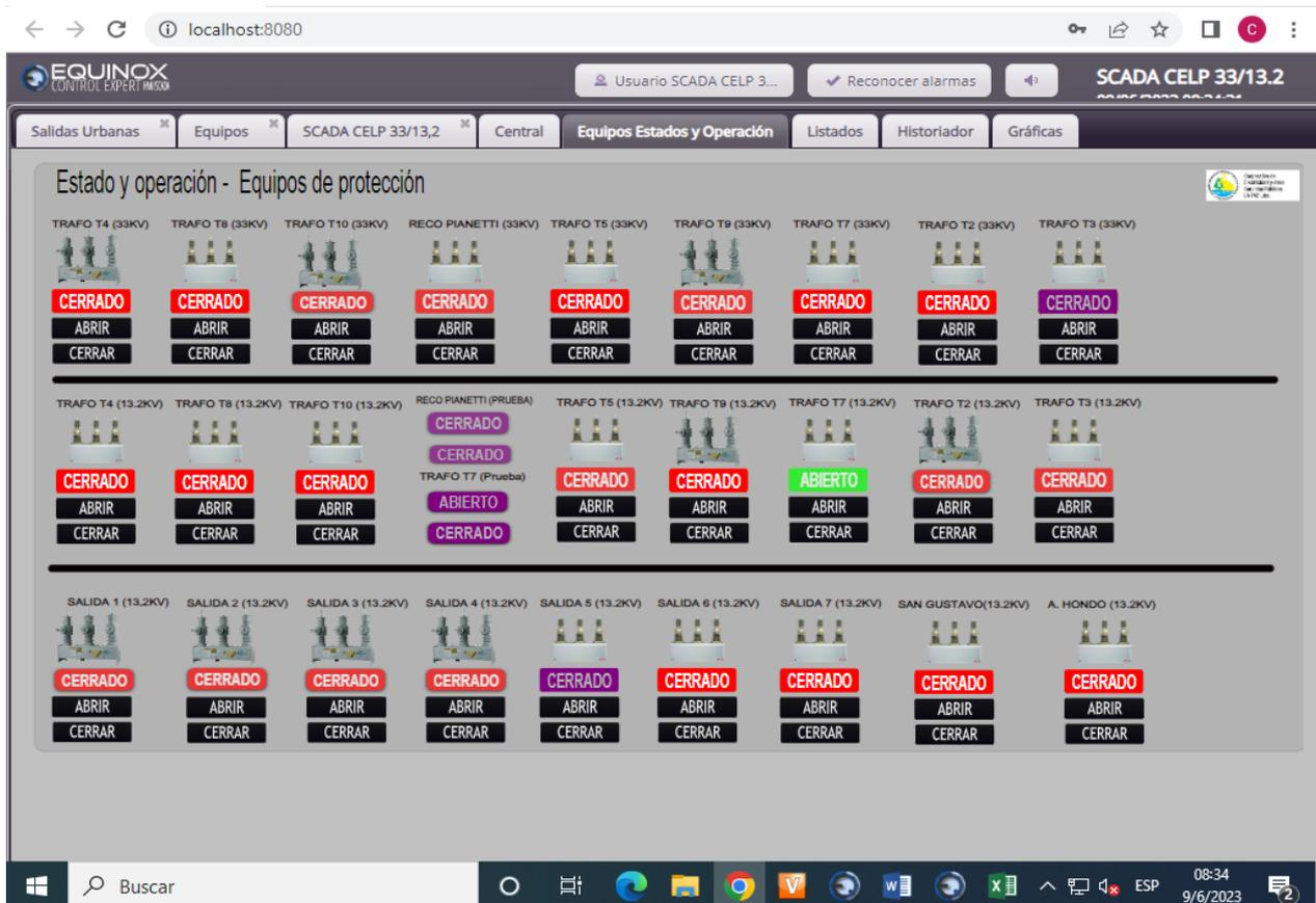
Fig. 84- Pantalla de Equipos de protección- Estado y operación
