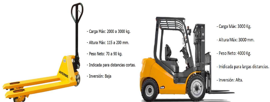
Figura 12: Características zorra vs autoelevador. Fuente: Página Web; www.jev-ar.com .
