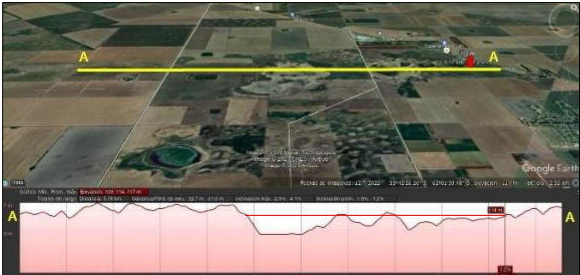
Figura 40: Cota del pelo de agua máximo de permanencia hasta 192 hs. (8 días).
