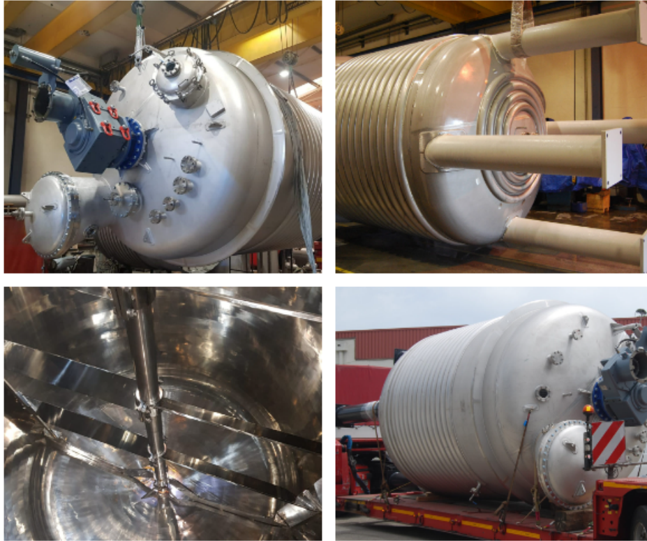
Figura Nº 2: Reactor Caldería Teruel de 50 m 3 , exterior e interior con su sistema de agitado.
