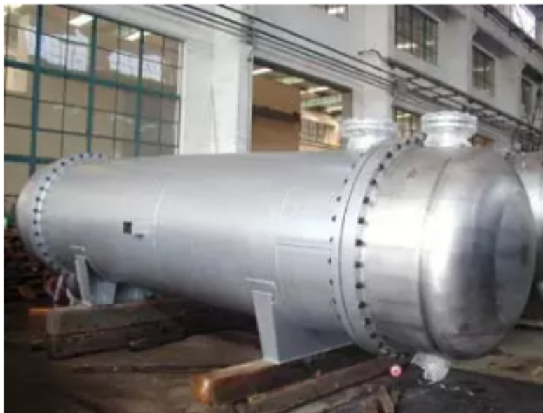
Figura N°10: Intercambiador de calor marca NYM modelo NYMHE190136
