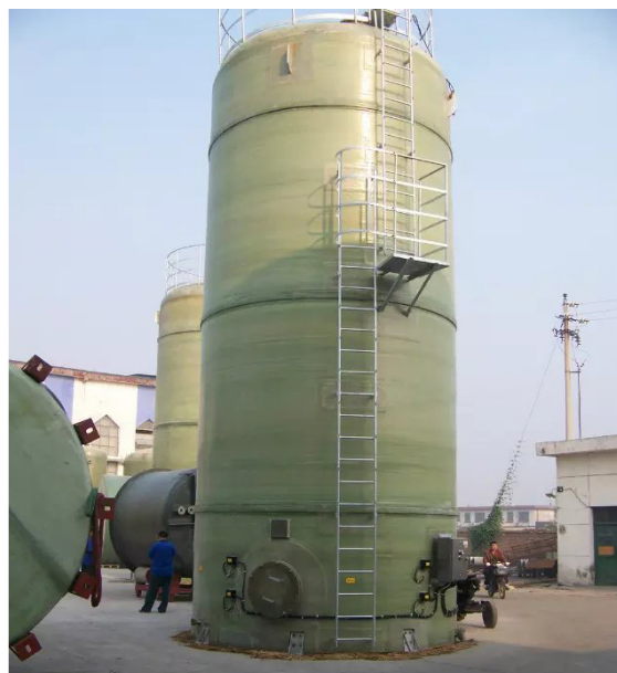
Figura N°46: Tanque de almacenamiento para ácido acético
