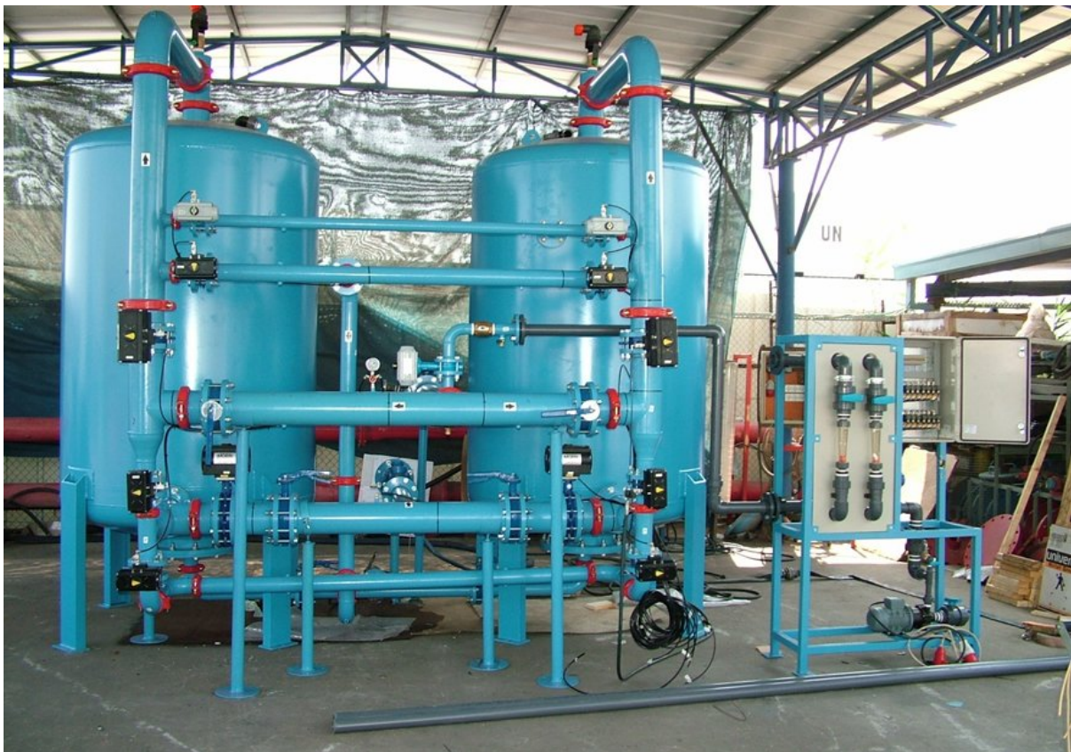
Figura N°7: Ablandador de agua Marca Filtomat Water Systems
