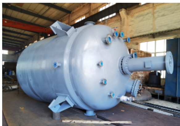
Figura N°13: Reactor FCH-50m 3 marca HXCHEM
