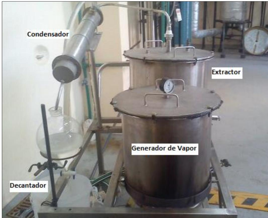
Figura 4: Fotografía del equipo de destilación por arrastre con vapor de agua a escala piloto.
