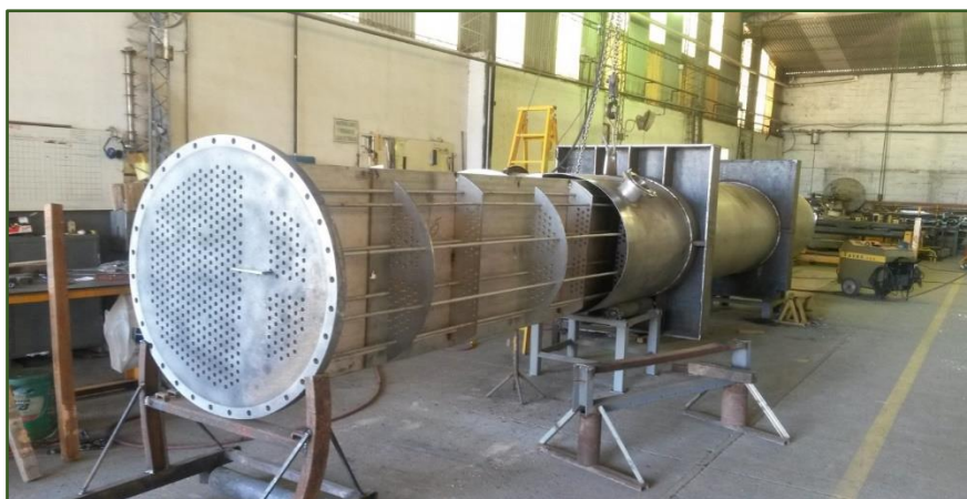
Figura 81. Imagen esquemática condensador de CO 2
