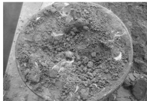
Figura 2. Fibra sintética de 19 mm incorporada al suelo limoso.
