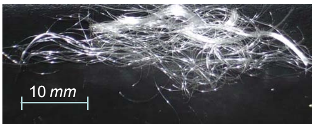
Figura 2. Fibra sintética de 19 mm incorporada al suelo limoso.
