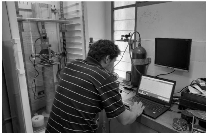
*Figura 14.3. Determinación de módulo dinámico en testigo de pavimento asfáltico*
