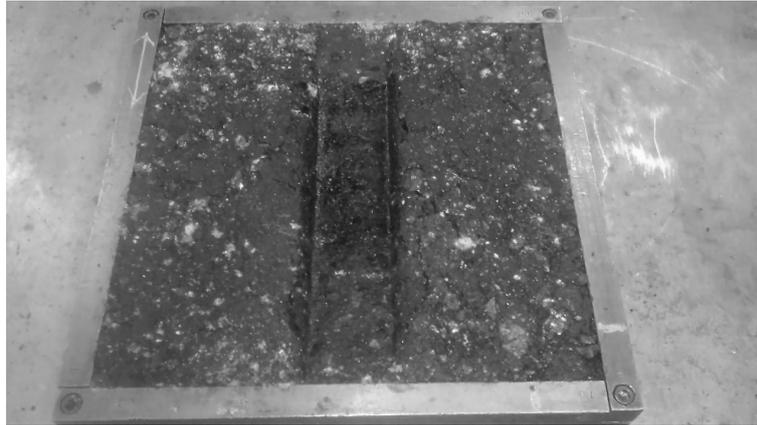
*Figura 24.2. Análisis con WTT de mezcla de RAP con aceite usado de motores*
