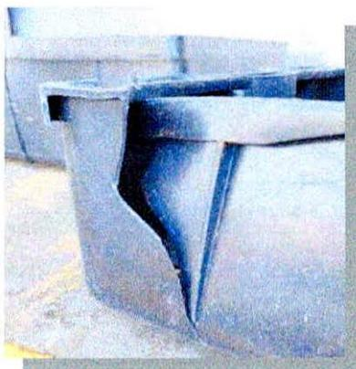
*Figura 10 – Cajón roto de polietileno de alta densidad*
