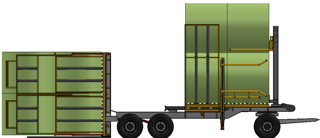
Figura 4. 3 - Vista lateral. Etapa de vuelco
