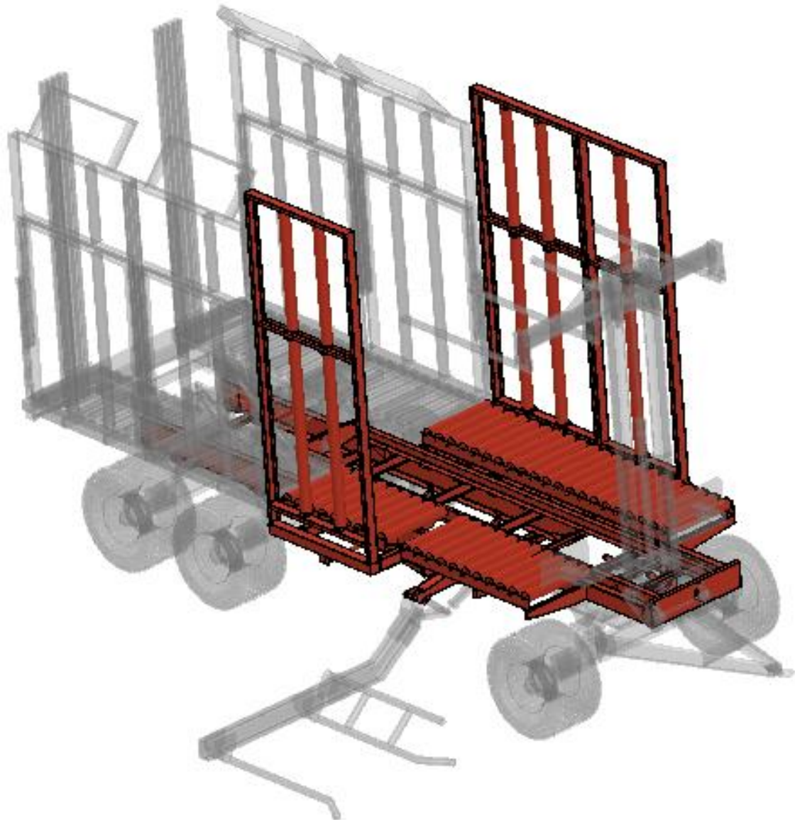
Figura 6.1 - Conjunto chasis y plataforma fija
