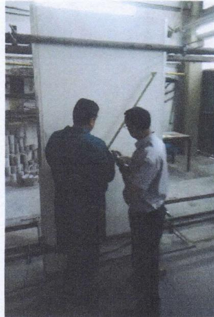
Figura 6: Medición deformación permanente
