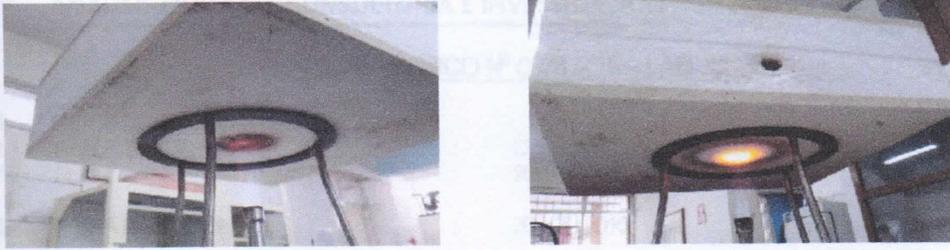
Fig. n°9 : Muestra durante el ensayo de resistencia al fuego.
