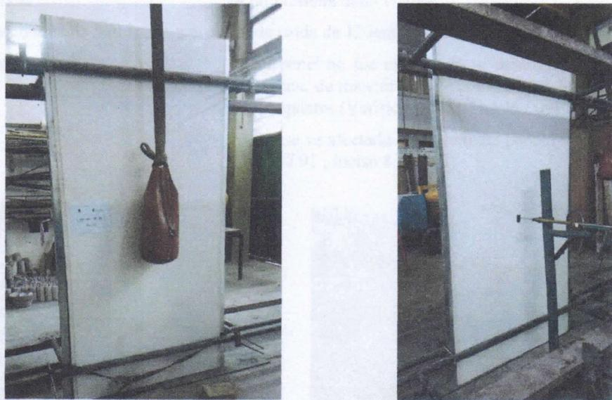
Figura 3: Ensayo panel – Ubicación del deflectómetro.
