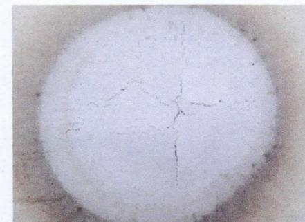
Fig. n°8: Muestra expuesta al fuego por 8h
