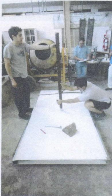
f) Medición de altura de caída la bola de acero.
