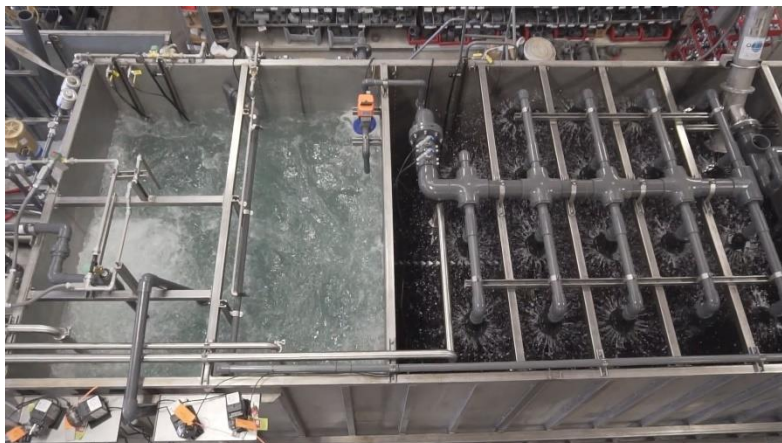
Ilustración 10.6-2: Bioreactor Aeróbico para el Tratamiento de Aguas Residuales. Fuente: https://www.synertech.com.co/aguas-residuales/sistemas-de-tratamientos-biologicos
