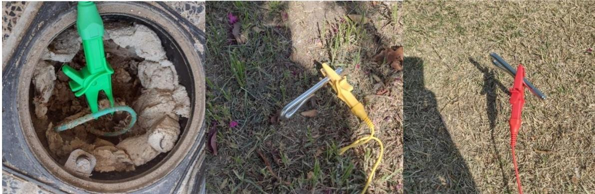
**Figura 32.** Conexión de los diferentes cables del equipo a su respectiva jabalina.
