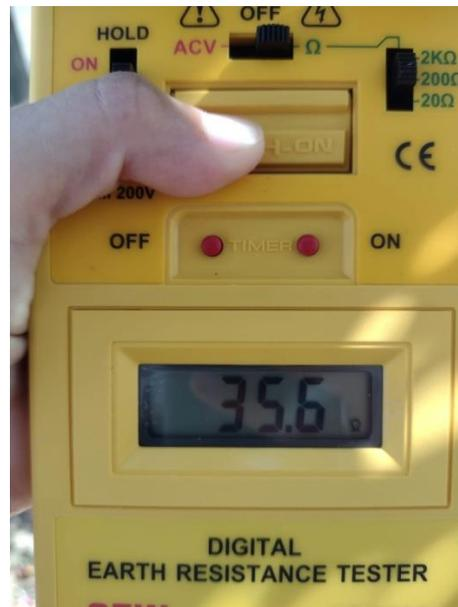
**Figura 34.** Medición de resistencia de puesta a tierra.
