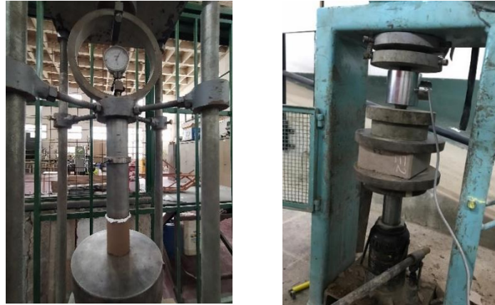
Figura 3: Realización del ensayo de resistencia a compresión seca sobre probetas cilíndricas y BTC.
