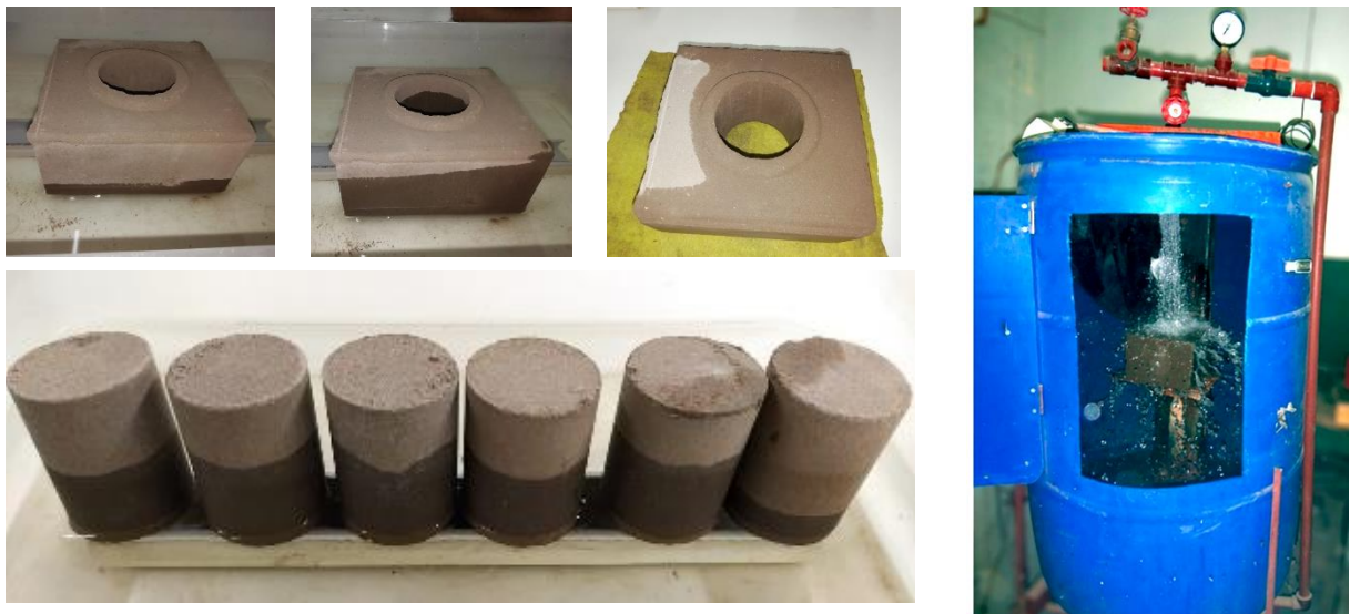
Figura 5: Realización del ensayo de absorción de agua por capilaridad (izquierda) y erosión por pulverizado de agua a presión (derecha)
