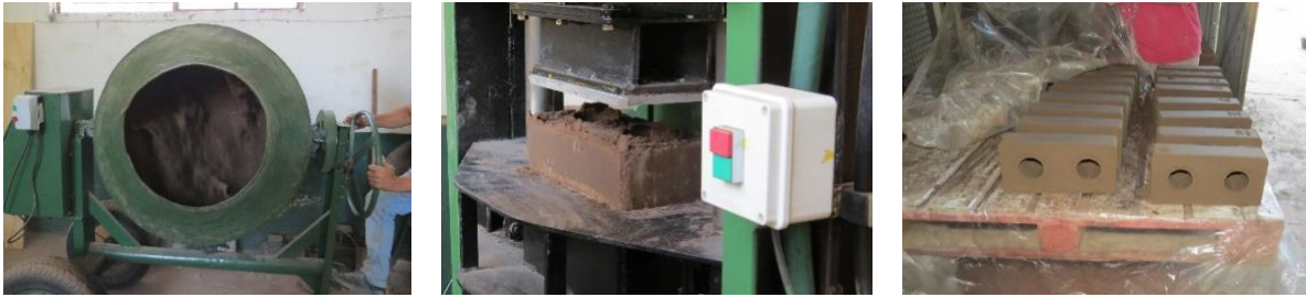
Figura 1: Proceso de fabricación de BTC en la planta de Eco3 Ingeniería: Mezclado de la materia prima; prensado de un bloque y acopio de BTC para ser curados.
