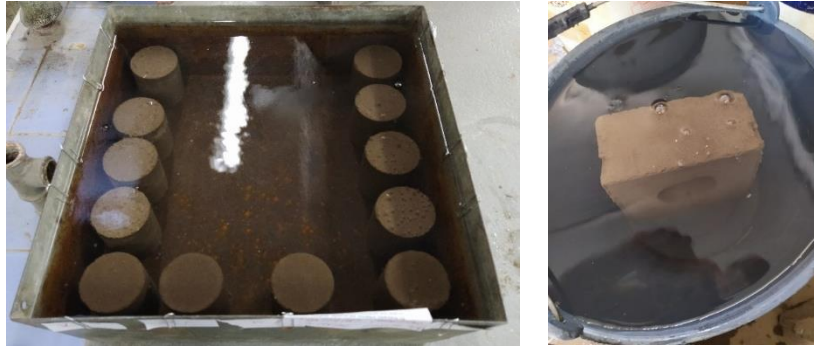
Figura 4: Probetas cilíndricas y BTC completamente sumergidos para evaluar su absorción de agua por inmersión y resistencia a compresión saturada.
