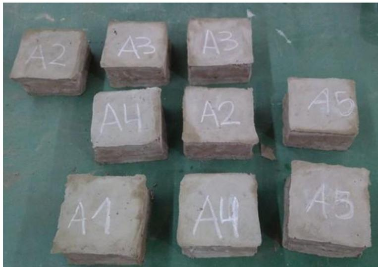
Fig. 3: Medios adobes de la serie Monte Vera encabezados para la realización del ensayo de resistencia a compresión.
