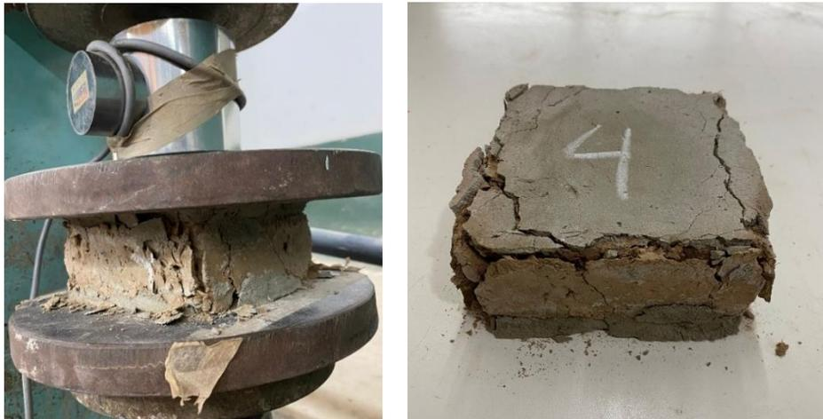
Fig. 4: Ensayo de resistencia a compresión sobre una probeta de la serie Santa Rosa.
