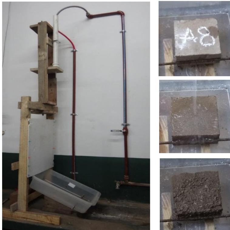
Fig. 5: Ensayo de Resistencia a Erosión Húmeda de la serie Monte Vera.
