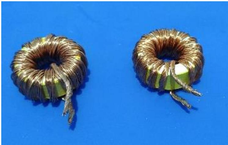
**Fig. N°29** *Inductancias construidas con el hilo de Litz y núcleo toroidal.*
