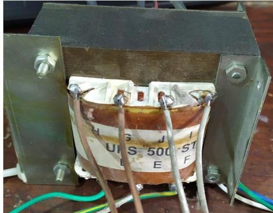
**Fig. N°27** Transformador 220V/6V.
