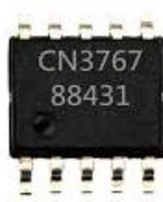
**Fig. N°22** Circuito integrado CN3767.
