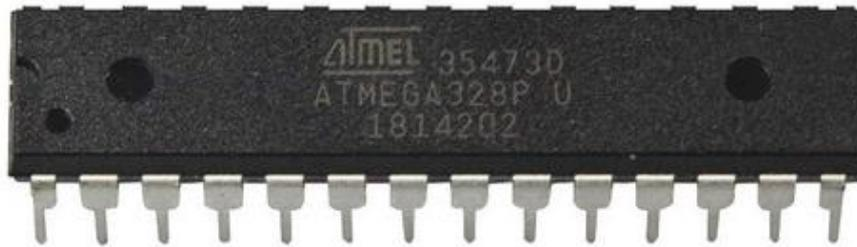
**Fig. N°16** Microcontrolador ATmega328P.
