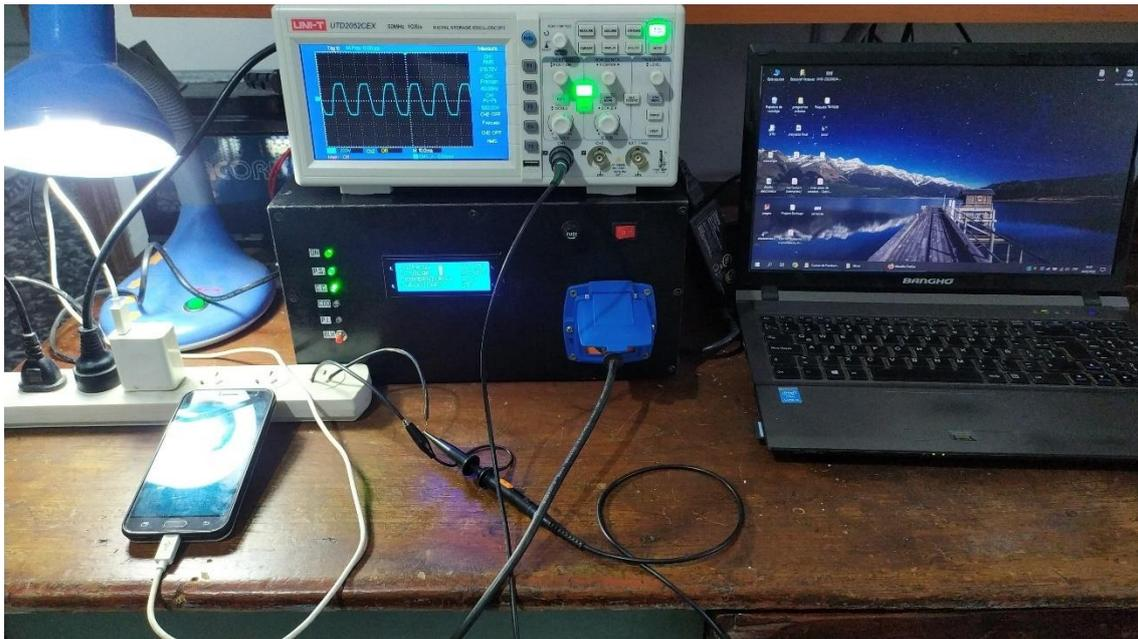
**Fig. N° 92** Forma de onda a la salida del inversor con tres cargas.
