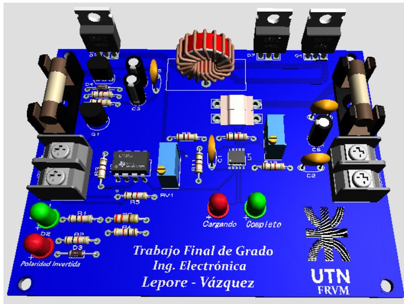
Fig N°34 Diseño del PCB en 3D del regulador/cargador
