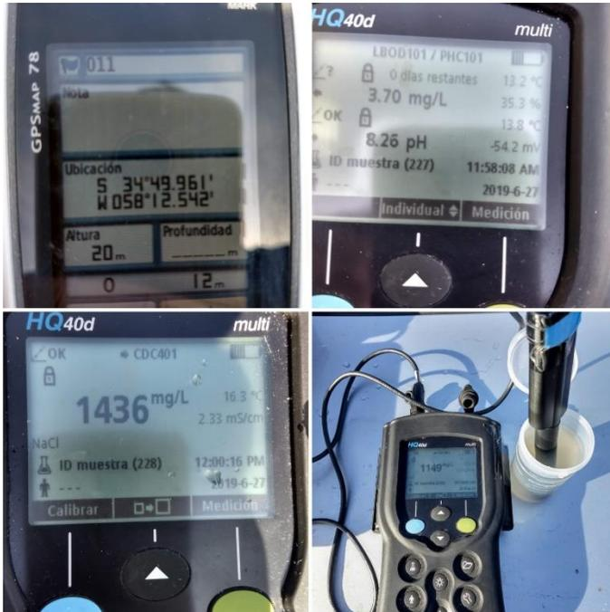
ILUSTRACIÓN 4- EQUIPO MULTIPARAMÉTRICO HACH HQ40D UTILIZADO EN CAMPO
