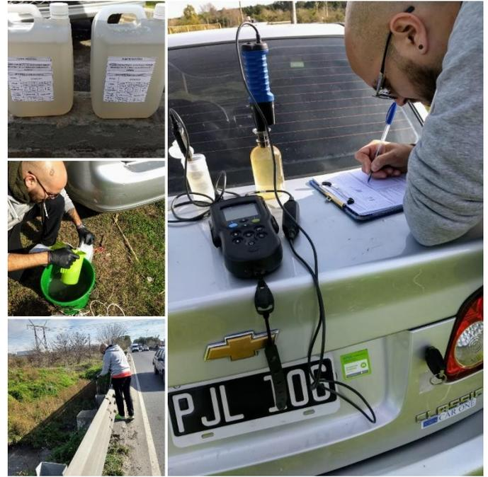
ILUSTRACIÓN 2- MEDICIÓN Y REGISTRO *IN SITU* DE PARÁMETROS CON MULTIPARAMÉTRICO (ESTACIÓN MONITOREO M2)
