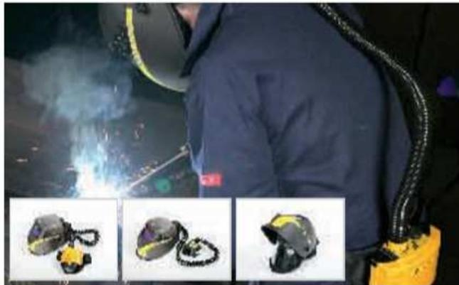
Pantalla de soldadura asistida con línea de aire. ESAB – CONARCO
