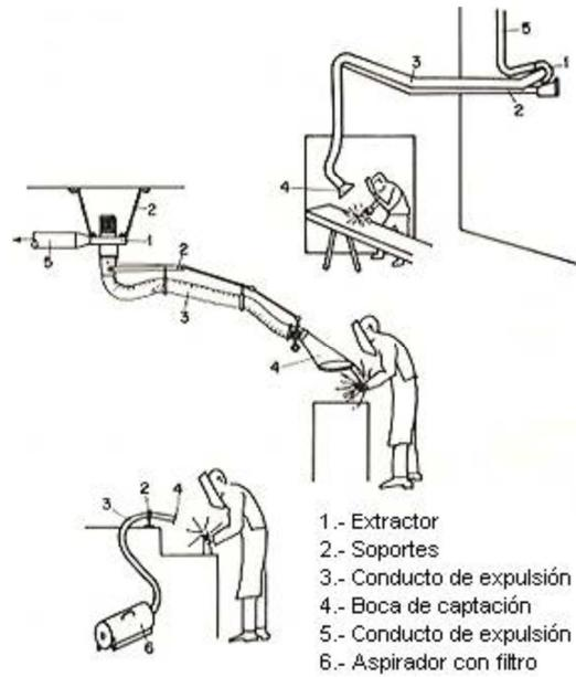
El caudal de aspiración necesario en este caso depende en gran medida de la distancia entre la boca de aspiración y el punto de soldadura. Los valores normalmente empleados se reflejan en la tabla siguiente:
