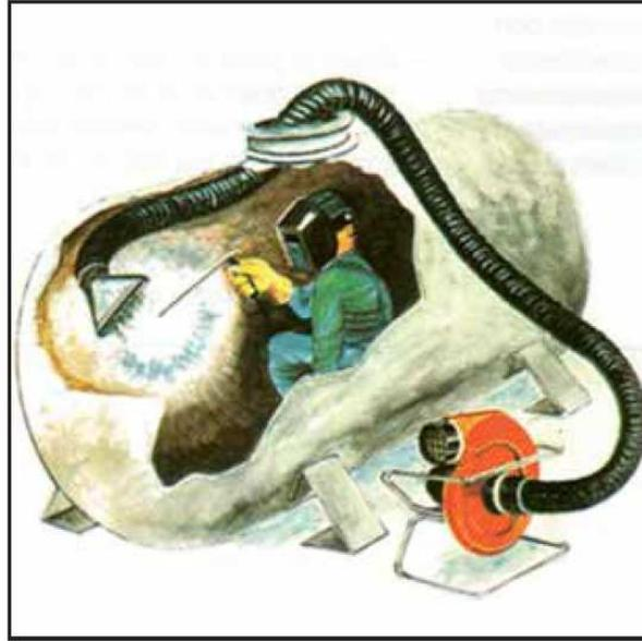
**Ventilación en un espacio confinado mediante extracción localizada.**
