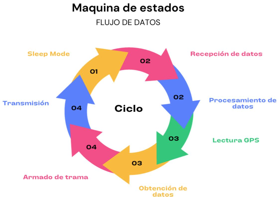
Figura 28. Diagrama de máquina de estados.
