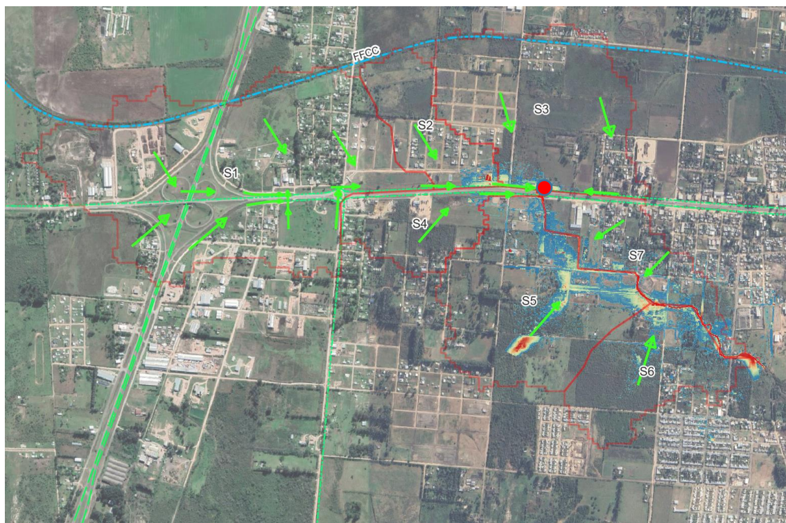
Figura 8 - Esquema general de escurrimiento en cuenca del Arroyo Las Mellizas
