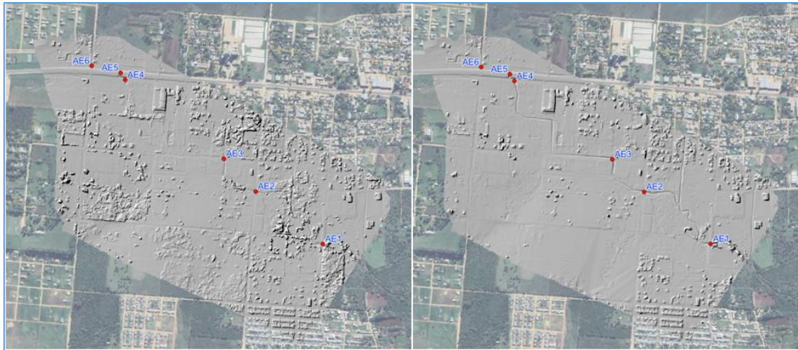
Ilustración 13 – Modelo digital antes y después de procesado para eliminación de vegetación y generar las canalizaciones y alcantarillas existentes.
