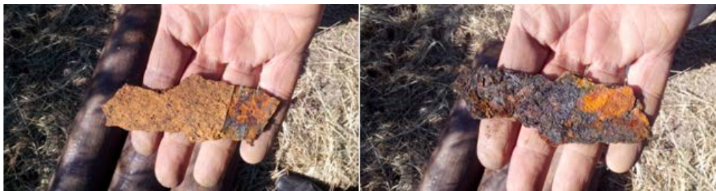
Figura 6: Coloración incrustaciones. Superficie externa, izquierda. Superficie interna, derecha.
