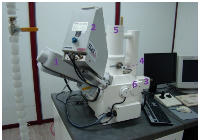
Figura 3: Microscopio Electrónico de Barrido. (1) Espectrómetro WDS, (2) Espectrómetro EDS, (3) Detector de electrones retrodifundidos, (4) Detector de electrones secundarios, (5) Cañón del microscopio y (6) cámara.
