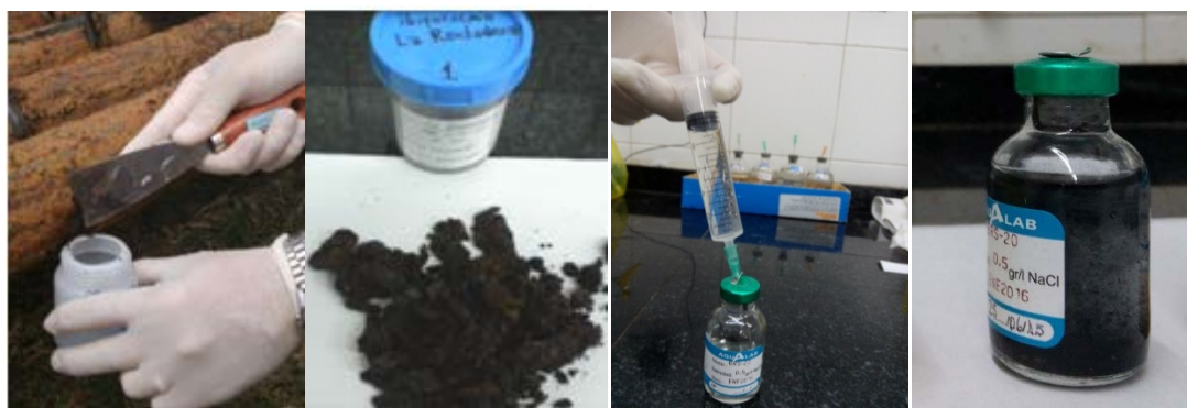
Figura 2: (de izq. a der.). Muestreo. Muestra. Inoculación. BRS positivo.
